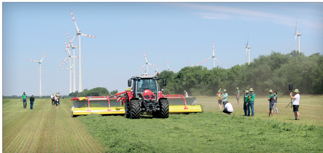
Na pozemku, posečeném pod taktovkou navigačního systému, může být i traktor se shrnovačem řízený navigačním systémem a formovat pravidelné a rovné řádky. Sklizeň takových řádků je pak snazší a rychlejší, nehledě na lepší práci řezacího ústrojí lisů či senážních vozů
