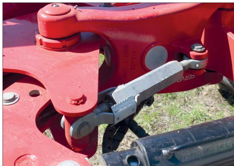
Přehledná stupnice pomáhá najít správné nastavení vřetene podle vnitřní šířky rozchodu traktoru
