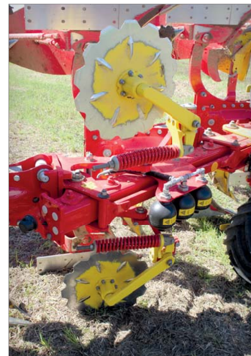
Prezentovaný pluh Servo 3000 Nova Plus byl vybaven odpruženým ozubeným krojídlem, možné jsou ale i další varianty. Trojice dusíkových akumulátorů je přesunuta na bezpečnější místo blíže k rámu pluhu, kde je lépe chráněna před poškozením
