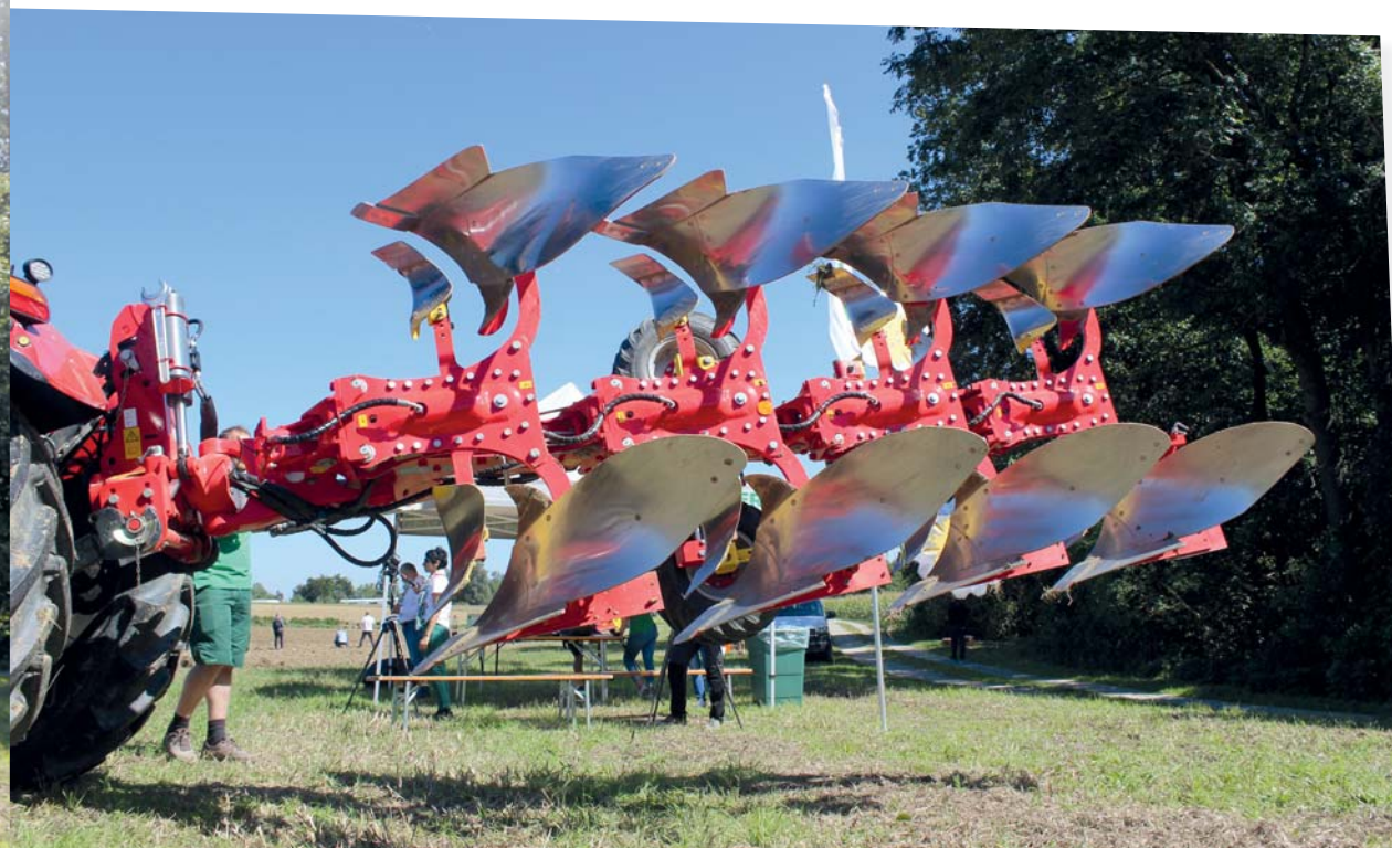
Pluhu Servo 3000 mají nově vyvinutý systém nonstop jistění orebních těles proti přetížení Nova. Hydraulický válec je uložený uvnitř, kde je spolehlivě chráněn před poškozením a vnikáním nečistot
