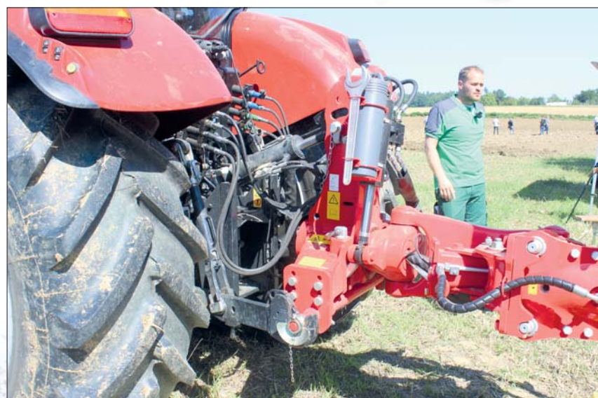
Robustní otoč v nové podobě a propracovaná konstrukce rámu zajišťují dlouhodobé a bezpečné používání. Srdcem otočného závěsu je dutý hřídel s průměrem 110 mm
