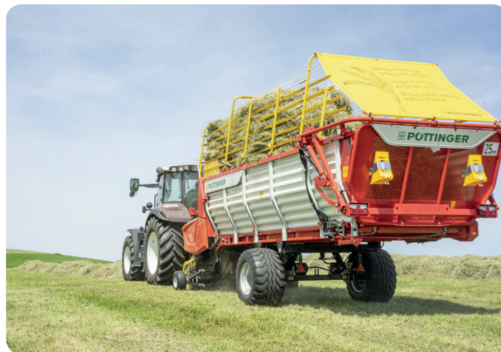
U hydraulicky sklopné nástavby na suchou hmotu došlo také ke změnám. Může být doplněna o automatiku plnění. Na přání lze nástavbu osadit sítí, která zabraňuje vypadávání krátké píče prostory mezi vzpěrami
