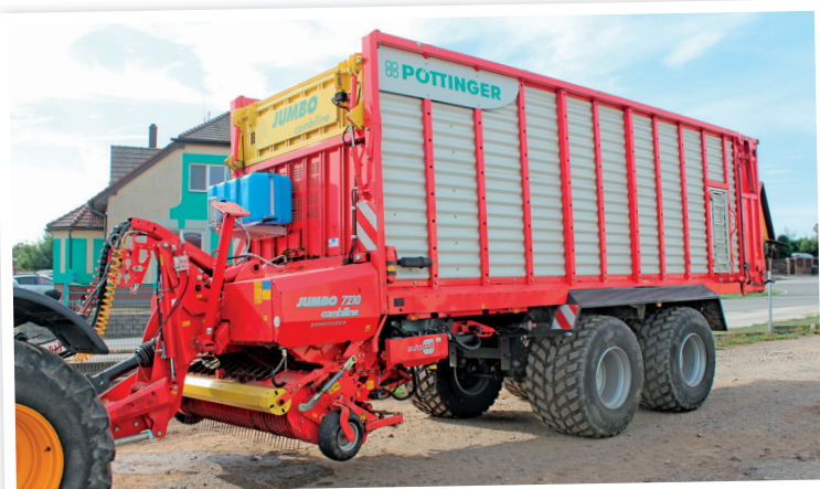
Jedním z trojice senážních návěsů firmy Pöttinger ve společnosti AGRA Březnice je Jumbo 7210 Combiline. I přes intenzivní nasazení s těmito návěsy nikdy nebyl v podniku problém. Tandemový podvozek má hydropneumatické odpružení, které velmi efektivně tlumí rázy od kol při přejezdu nerovností
