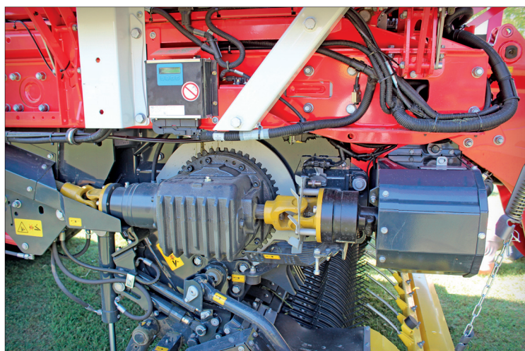
Na pravé straně vozu Jumbo 8540 se nachází úhlová převodovka. Od ní pokračuje pohon dále: nejprve je prostřednictvím robustní převodovky Rockinger poháněn plnicí hvězdicový rotor. Druhý výstup z převodovky slouží k vedení pohonu rozdrůzovacích válců, jenž je v převodovce také zapínán (je-li jimi návěs vybaven)
