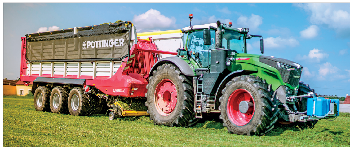
Jumbo 8540 je největší návěs nové řady osm tisíc. Disponuje objemem ložné plochy 54 krychlových metrů podle DIN. Při shodné délce návěsu si dokáže naložit více hmoty než vůz Jumbo 10010 L Combiline, také díky pohyblivé přední stěně
