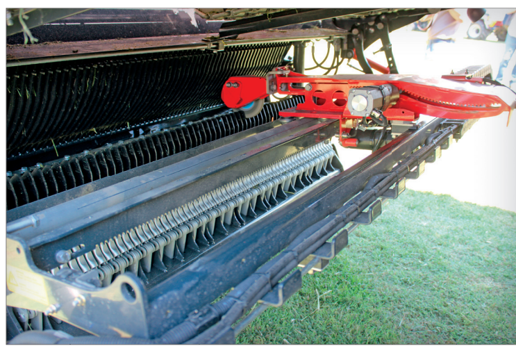
Nový, elektronicky ovládaný a elektricky poháněný Autocut má nový počítač. Zatímco dříve se tu a tam na fungování systému negativně projevila nízká teplota hydraulického oleje, tak nyní tento problém odpadá. K dalším výhodám patří prodloužení životnosti a ještě rychlejší nabroušení nožů
