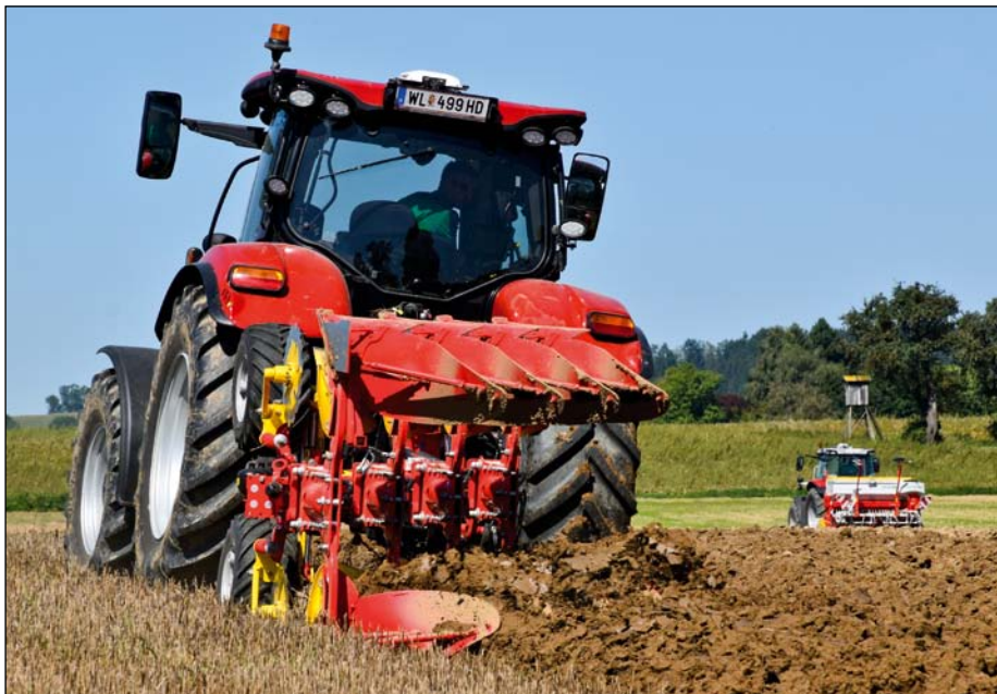
V ponuke sú pluchy SERVO 3000 s tromi až piatimi radlicami, s rôznou vzdialenosťou telies a výškou rámu.
