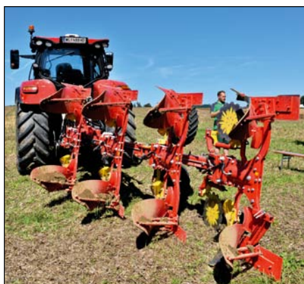
Výbava SERVO 3000 PLUS disponuje hydraulickým nastavením šírky brázdy a ešte vyšší komfort pre obsluhu ponúka SERVO 3000 PLUS NOVA.
