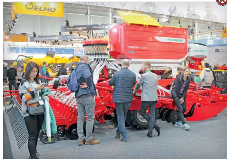
Pro rok 2024 přichází firma Pöttinger s komfortním ovládáním všech hydraulických funkcí secích strojů Terrasem. Stroj je zásobován olejem pouze systémem Load Sensing traktoru a veškeré nářadí je ovládáno elektrohydraulicky přes hydraulický blok
