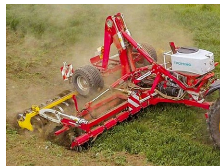
Diskový podmietač TERRADISC 6001 T s pracovným záberom 6 m, ktorý je vybavený tandemovým valcom CONOROLL a sejacím strojom TEGOSEM.
