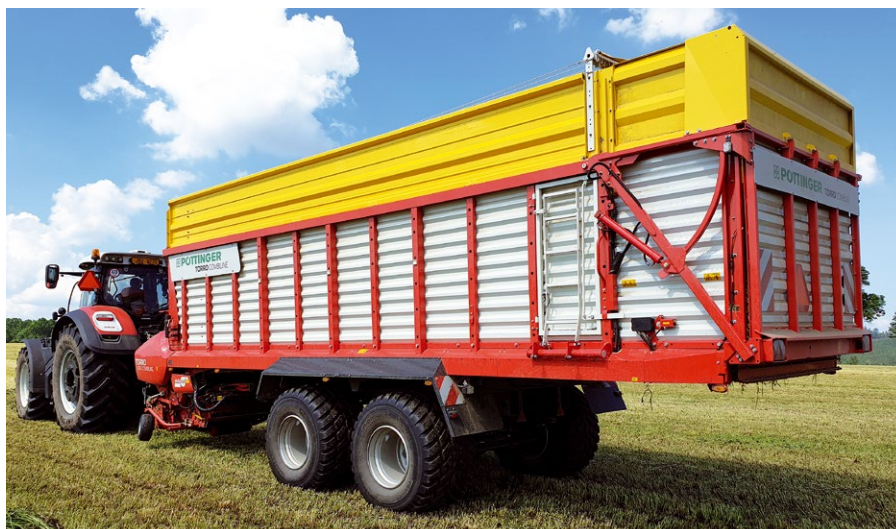
Víceúčelový samosběrací vůz TORRO 8010 L COMBILINE s objemem 43 m 3 má za sebou pět sezon.
