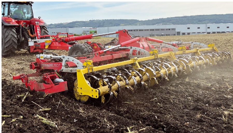
Diskový podmítač TERRADISC 8001 T je vybavený dvojitým segmentovým válcem TANDEM CONOROLL.
