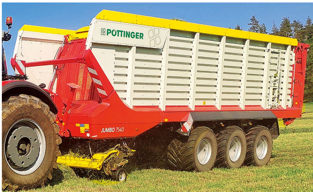
Víceúčelový samosběrací vůz s válcovým vkládacím ústrojím JUMBO 7540 nabízí ložný prostor 54 m 3 .
