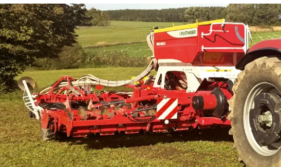
Univerzální secí stroj TERRASEM C6 má pracovní záběr 6 metrů. S traktorem 270 k zaseje za sezonu kolem 350 ha.
