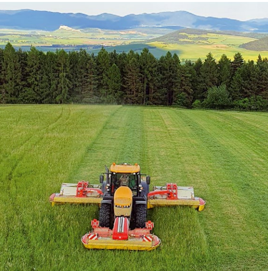
Disková žacia kombinácia NOVACAT V10 RC COLLECTOR so zhadzovacími pásmi a čelným žacím strojom NOVACAT 301 RC ALPHA MOTION.
