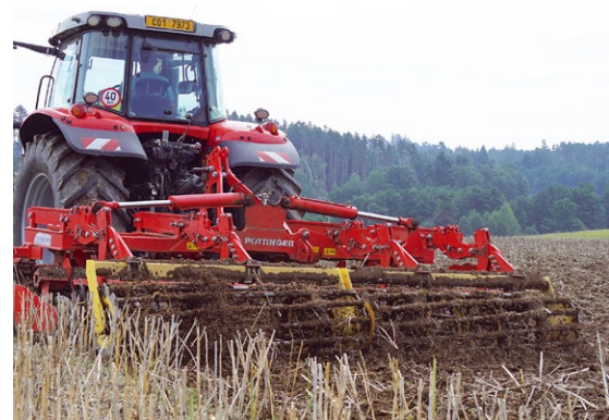
Čtyřmetrový diskový podmiťáč TERRADISC 4000 K.
