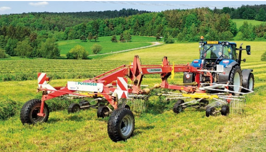
Jeden ze dvou dvourotorových stranových shrnovačů TOP 652 s pracovním záběrem 6,40 m.
