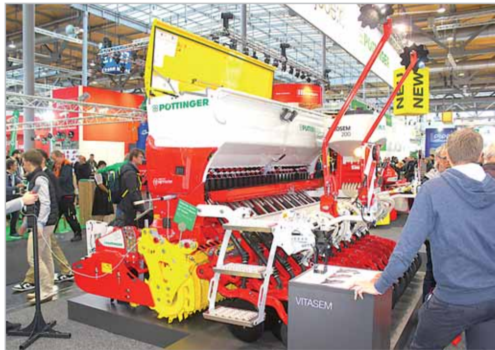
Mechanický secí stroj Vitasem M 3000 DD je velkou novinkou. Oproti předchozí generaci se objem zásobníku jednotlivých modelů zvýšil, na přání je možný elektrický pohon výsevních válečků a možné je i doplnění o secí stroj Tegosem 200 Foto Petr Beneš
