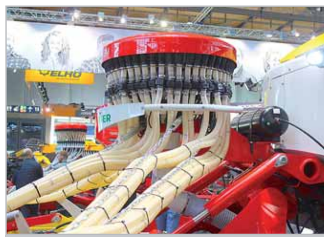
Rozdělovací hlava IDS nabízí zcela nové možnosti dávkování a ukládání osiva do řádků včetně kolejových Foto Petr Beneš
