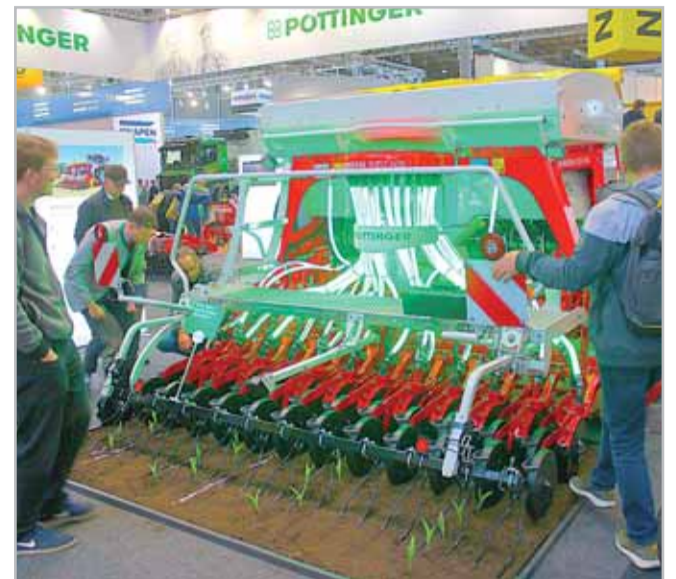
S konceptem pneumatického secího stroje Aerosem 3002 ADD (PCS) IDS se firmě Pöttinger podařilo perfektně zacílit na rodinné či středně velké zemědělské podniky se zaměřením na chov skotu či se smíšenou produkcí. Zájem návštěvníků na stánku to potvrdilo Foto Petr Beneš
