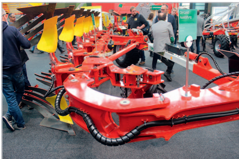
Polonesený pluh Servo T 6000 Nova Plus v provedení pro orbu on-land může být agregován i s pásovými tahači či traktory s dvojmontážemi pneumatik. Kdykoli je možné přechopení pro provoz traktoru v brázdě
