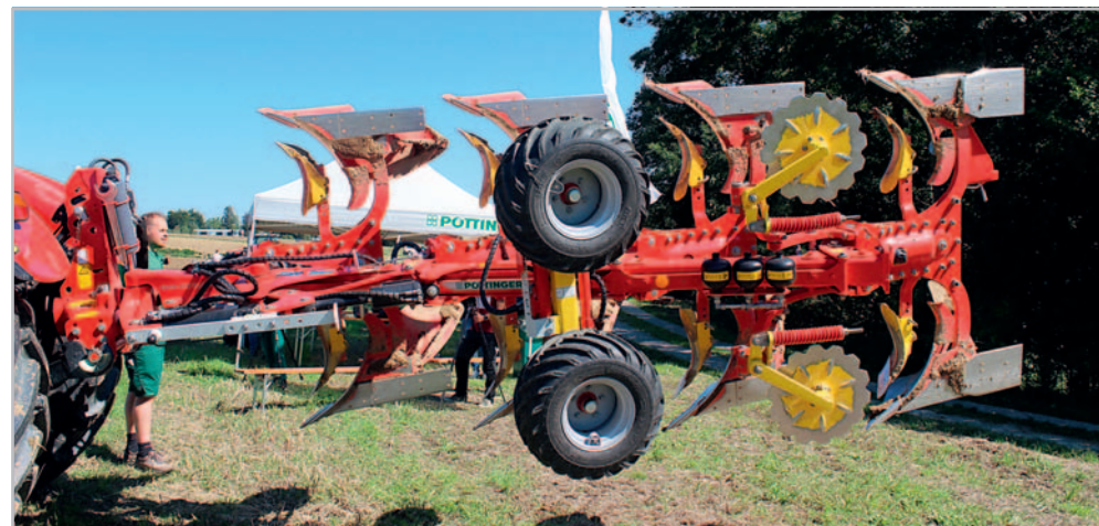
Pluh Servo 3000 mají nově vyvinutý systém nonstop jištění orebních těles proti přetížení Nova. Hydraulický válec je uložený uvnitř, kde je spolehlivě chráněn před poškozením a vnikáním nečistot
