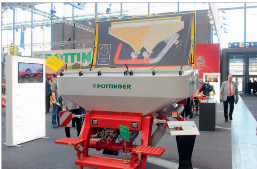
Čelně nesený zásobník Pöttinger Amico F je rozdělen na dvě komory v poměru 60 : 40. Každá komora má vlastní dávkovací ústrojí, oba komponenty dále putují společně. Zásobník je standardně vybaven ISOBUS kompatibilitou
