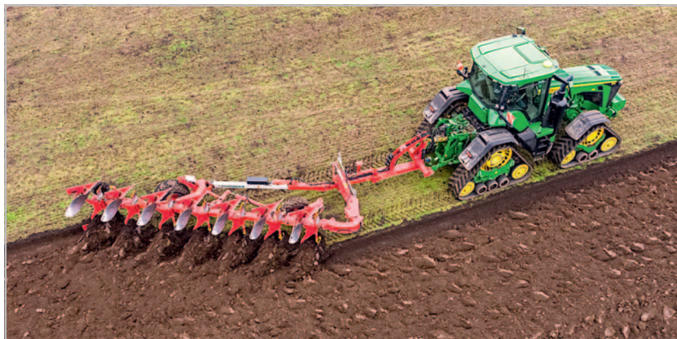
Při orbě on-land je záběr prvního orebního tělesa mimo traktor a pluh je tak vůči podélné ose soupravy vychýlen více do strany. To přináší i příznivější průběh tahové linie i rovnoměrnější zatížení kol či pásů
