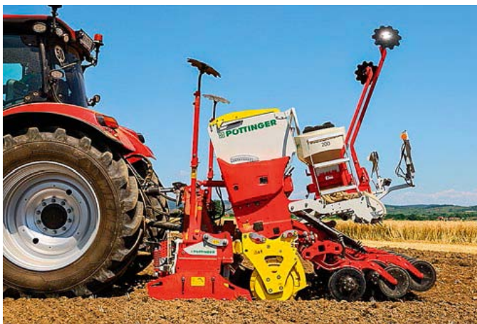
Príplatkový hydraulický horný bod zdvíha pätky a posúva ťažisko dopredu. Otočný bod je nad valcom.
