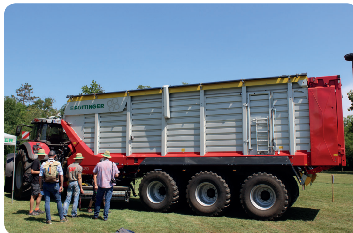
Teoretická délka řezanky 25 milimetrů – to je standardem pro nové návěsy Pöttinger Jumbo 8000. Je to možné díky 65 nožům v jejich výkyvném nosníku Easy Move
