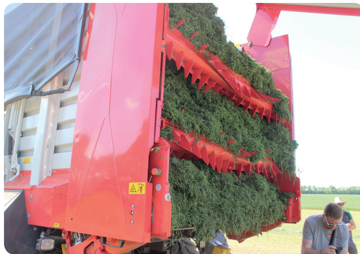
Návěsy s rozdrůžovacími válci umějí odkládat hmotu v rovnoměrné vrstvě na průjezdném silážním žlabu. Válce řezanku doplňkově provzdušní, takže se pak ještě snadněji rozvrstvěje a dusá
