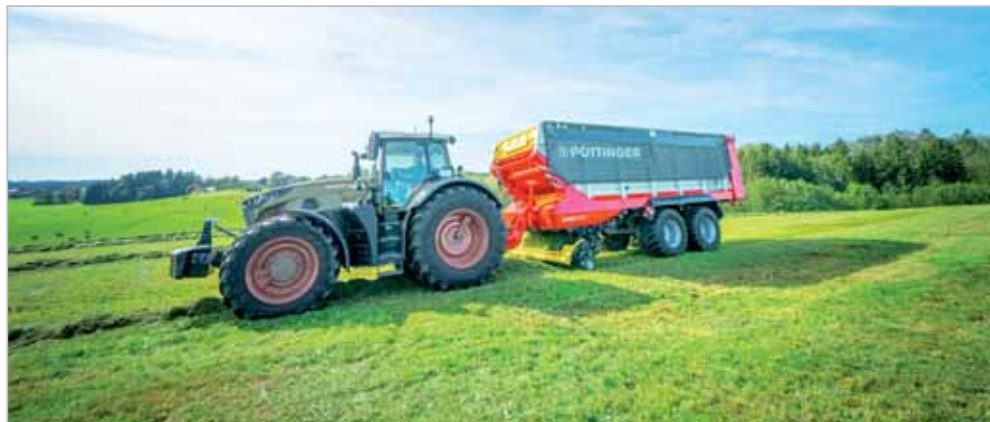
Návěs Pöttinger Jumbo 8450 DB pojme do své korby 45 krychlových metrů hmoty (podle DIN)
