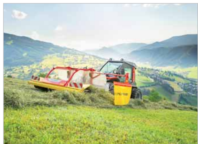
Čisté shrnování píce bez přejíždění koly traktoru nabízí řádkovač Mergento F 4010 Alpin pro přední tříbodový závěs
