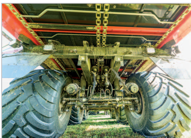
Hydropneumatické vyrovnání náprav zajišťuje konstantní tlak kol ve všech provozních situacích. Všechny hlavní komponenty brzd jsou umístěny na bezpečném místě nad středem nápravy
