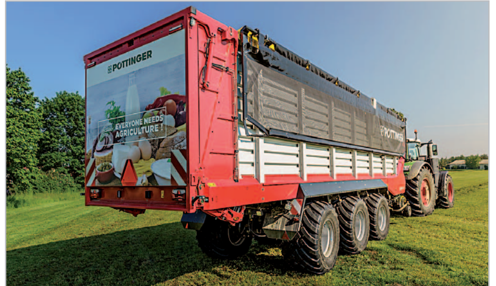
Jumbo 8540 je vybaveno zakrytím ložného prostoru pro fázi přepravy. Zařízení se skládá ze dvou podélných sklopných panelů s hydraulicky poháněným řetězovým kladkostrojem
