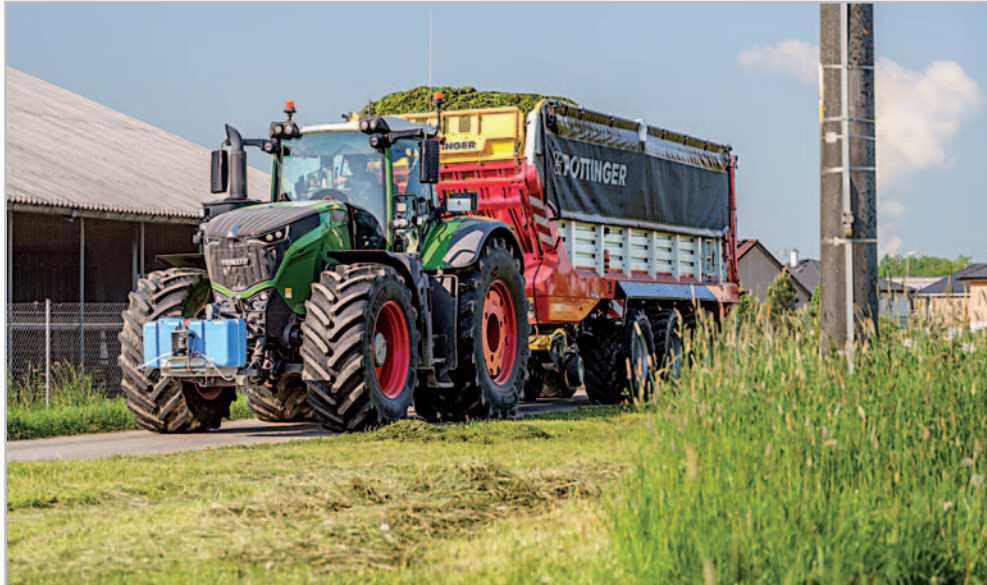
Jumbo 8540 je největší návěs nové řady osm tisíc. Disponuje objemem ložné plochy 54 krychlových metrů podle DIN. Při shodné délce návěsu si dokáže naložit více hmoty než vůz Jumbo 10010 L Combiline, což znamená rychlejší a efektivnější sklizeň
