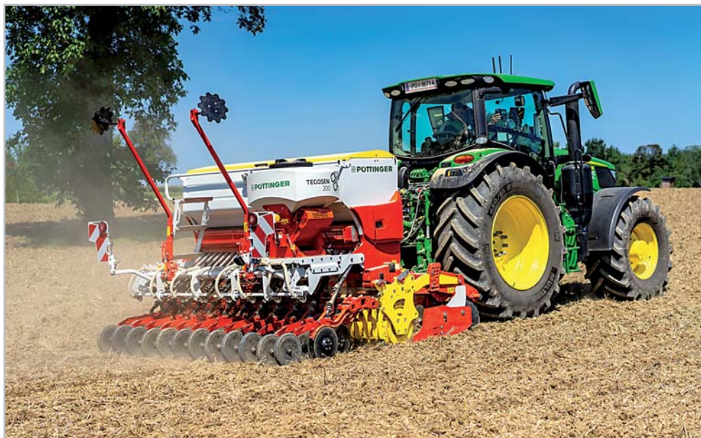
V kombinaci se secím strojem Pöttinger Vitasem umožňuje Tegosem aplikovat další komponenty
