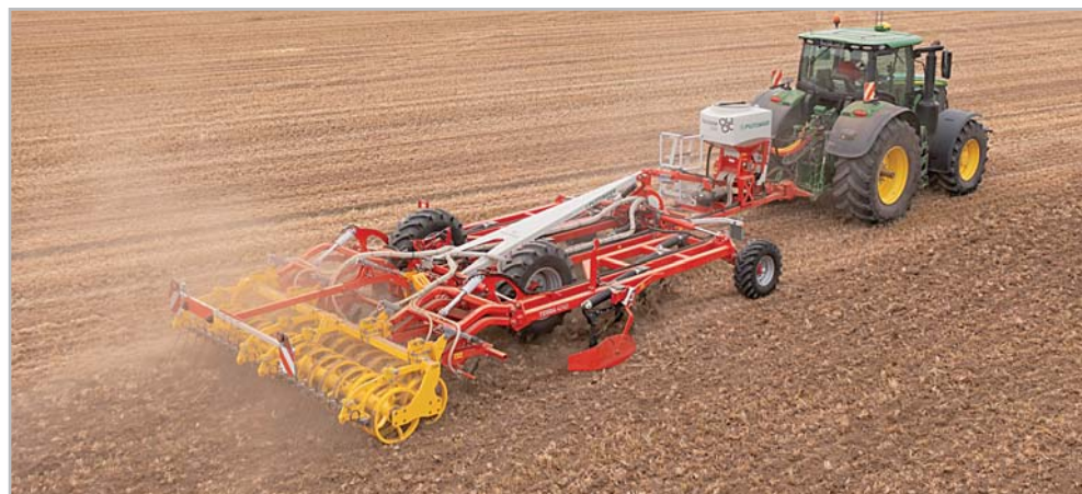
Zásobníkem Tegosem je možné osadit i stroje pro zpracování půdy a předsetovou přípravu. Třeba radličkový kypřič Terria
