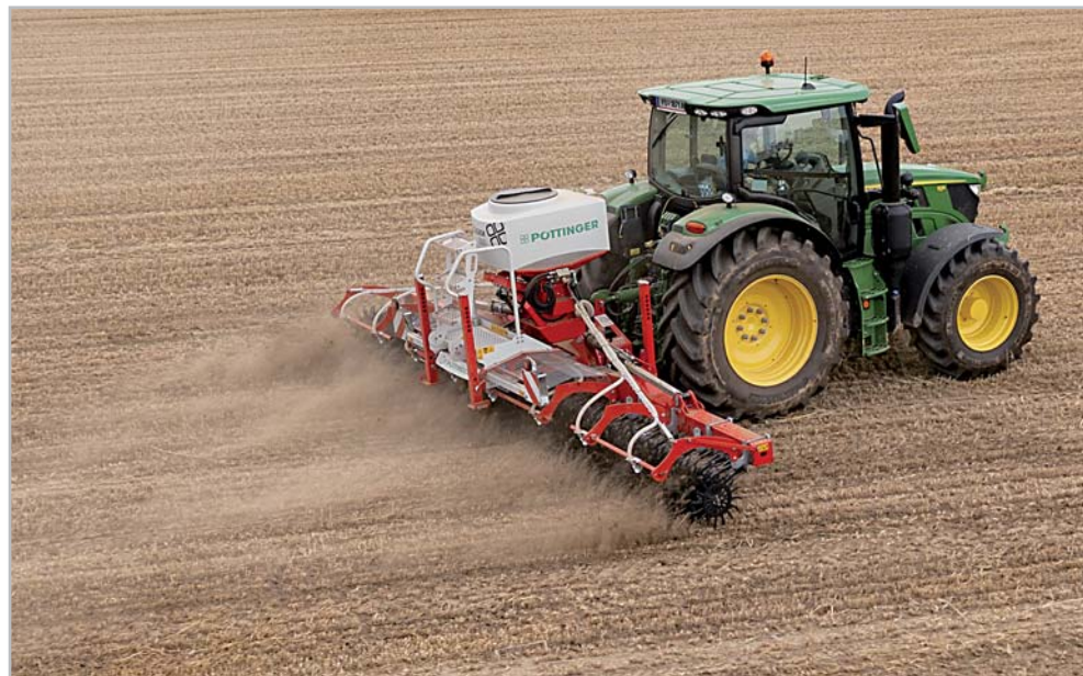
Rotační plečka Pöttinger Rotocare rozbíjí půdní škraloup, zatímco osivo se ukládá přímo za vyvýšený tok půdy
