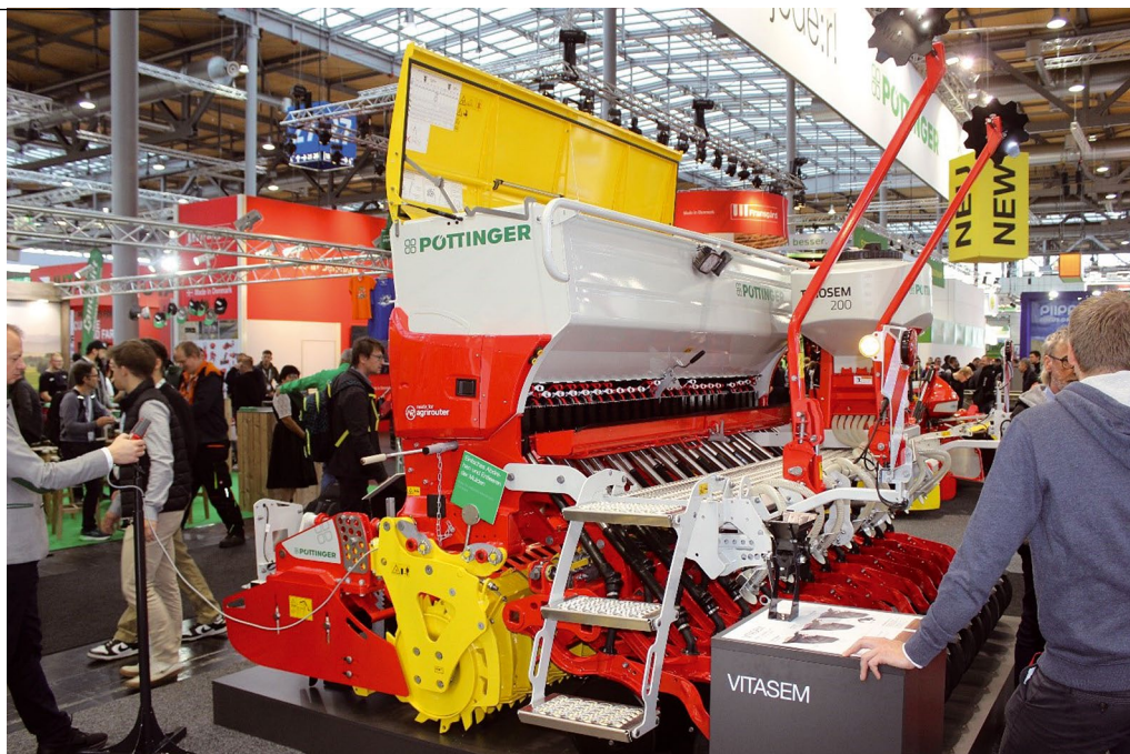
Mechanický secí stroj VITASEM M 3000 DD je velkou novinkou. Oproti předchozí generaci se objem zásobníků jednotlivých modelů zvýšil, na přání je možný elektrický pohon výsevních válečků a možné je i doplnění o secí stroj TEGOSEM 200.
