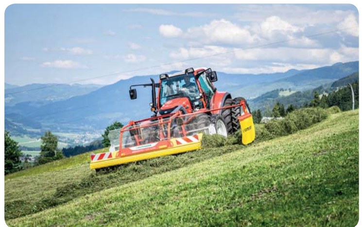
Nový řádkovač Mergento F 4010 Alpin se vyznačuje extrémně kompaktní krátkou konstrukcí a je tedy vhodný pro práci v podhorských a horských oblastech
