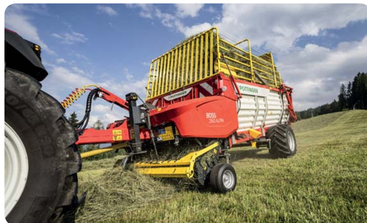
Sběrač u návěsů Boss 2000 Alpin má výrazně vylepšenou schopnost výkyvu a kopírování terénu také díky výkyvným vodicím kolům. Další optimalizaci lze dosáhnout aktivním ovládáním kloubové oje systémem Autotast
