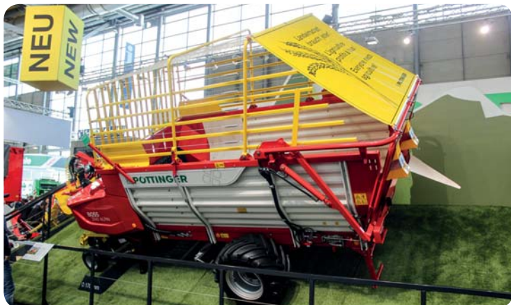
Široké pneumatiky se šípovým dezénem jsou u návěsů Boss 2000 Alpin umístěny po stranách nástavby vozu – typické řešení pro dosažení nízkého uloženého těžiště a maximální stability i na příkrých svazích
