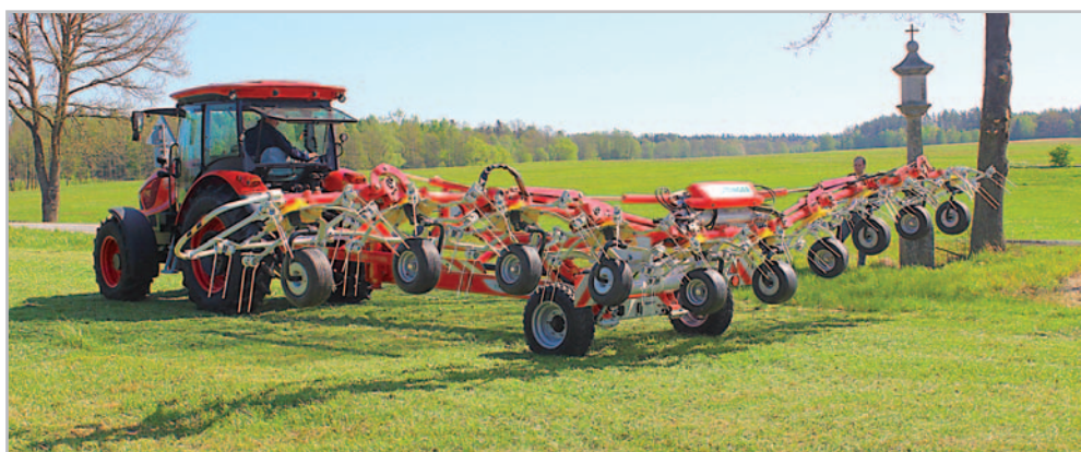
Na souvratích spočívá u obraceče HIT HT 11100 váha všech rotorů na nápravě. Při práci slouží podvozek obraceče též ke snímání povrchu pozemku Foto Petr Beneš
