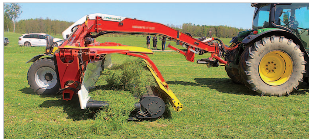
Pöttinger Mergento VT 9220 si poradí i s velice krátkou hmotou, která má jinak tendenci propadat do strniště. Díky aktivně řízeným sběračům a rozhrnovacím válečkům je příjem píce na pásové dopravníky rovnoměrný Foto Petr Beneš
