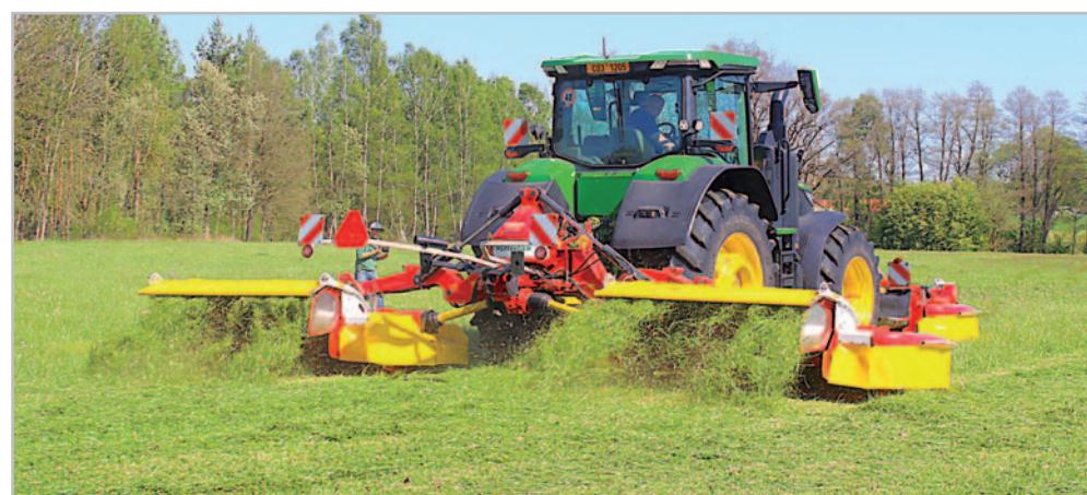
Nová žací kombinace NovaCat V 8400 ED je koncipována jako odlehčený model. Výhodou jsou menší nároky na výkon i hmotnost traktoru, ovšem shazovací dopravníky Collector nejsou možné Foto Petr Beneš
