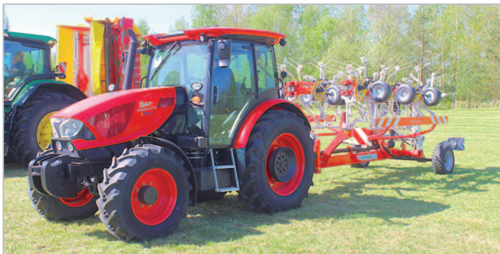
V transportní poloze vytváří tažený obraceč Pöttinger HIT HT 11100 s traktoem jednotku, která snadno projede i přes mostky či skrze nízké průjezdy Foto Petr Beneš
