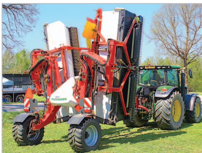
Řádkovač Mergento VT 9220 si lze na sklopných nosnících přizvednout, aby se zvýšila světlá výška pro vyjetí z pole Foto Petr Beneš
