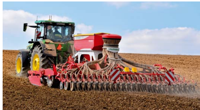
Sejací stroj Pöttinger Terrasem C6 agregujú s traktorom s výkonom 370 koní. Pri sejbe repky a sóje používajú len každú druhú výsevnú diskovú jednotku, dokážu tak siať na medziriadkovú vzdialenosť 30 cm, pričom možné je nastavenie aj na 45 cm.
