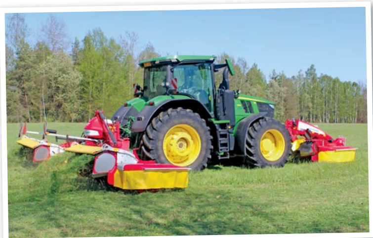
Nová žací kombinace NovaCat V 8400 ED je koncipována jako odlehčený model. Výhodou jsou menší nároky na výkon i hmotnost traktoru, ovšem shazovací dopravníky Collector nejsou možné
