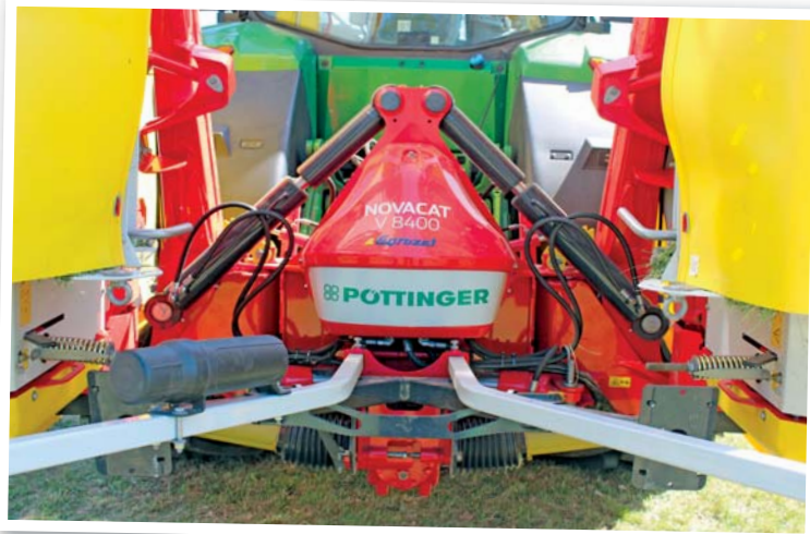
Žací kombinace NovaCat V 8400 ED se vyznačuje velmi krátkým závěsem a těžištěm v blízkosti traktoru. Hydraulické odlehčení je ve standardní výbavě
