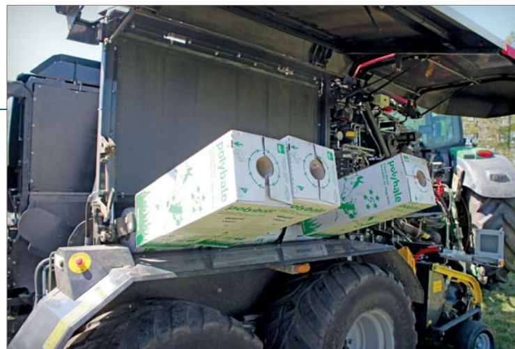
Povelem z kabiny či stiskem tlačítka na straně zásobníku se všechny role hydraulicky vykloupí a je možné je snadno vyjmout a přenést k ovíječce, případně doplnit nové. Těž zaklopení zpět je ovládáno hydraulicky
