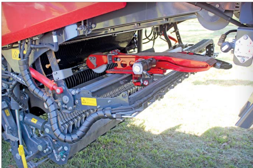
Ostrí v dobrém stavu po celý den lze udržovat díky automatickému broušicímu zařízení Autocut. Autocut nejnovější generace je poháněný elektrohydraulicky: posouvání broušicího ramene je poháněno hydraulicky, o pohyb ramene a pohon brusného kotouče se starají elektromotory
