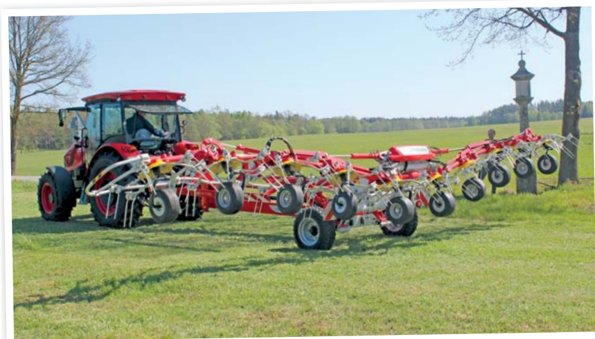
Na souvratích spočívá u obraceče HIT HT 11100 váha všech rotorů na nápravě. Při práci slouží podvozek obraceče též ke snímání povrchu pozemku
