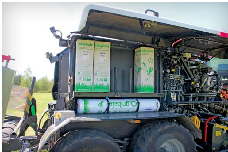
Pod bočním krytem lisu Impress 3160 VC Pro se nachází zásobník pro pět rolí fólie, určené pro ovíječku
