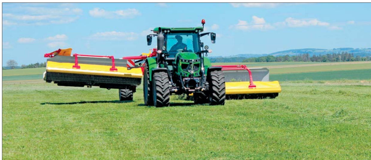
S řádkovačem Pöttinger Mergento VT 9220 lze pracovat také tak, že se jedna pracovní jednotka zdvihne nahoru a záběr se tak sníží na polovinu
