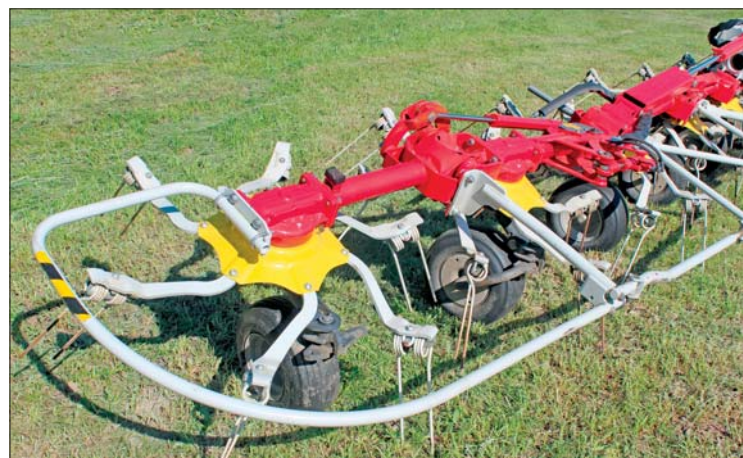
Předváděný obrabeč HIT 10.11 T byl vybaven systémem hraničního obracení. S pomocí dvojčinného hydraulického válce lze povel z kabiny traktoru vykývnout dvojici rotorů na pravé straně
