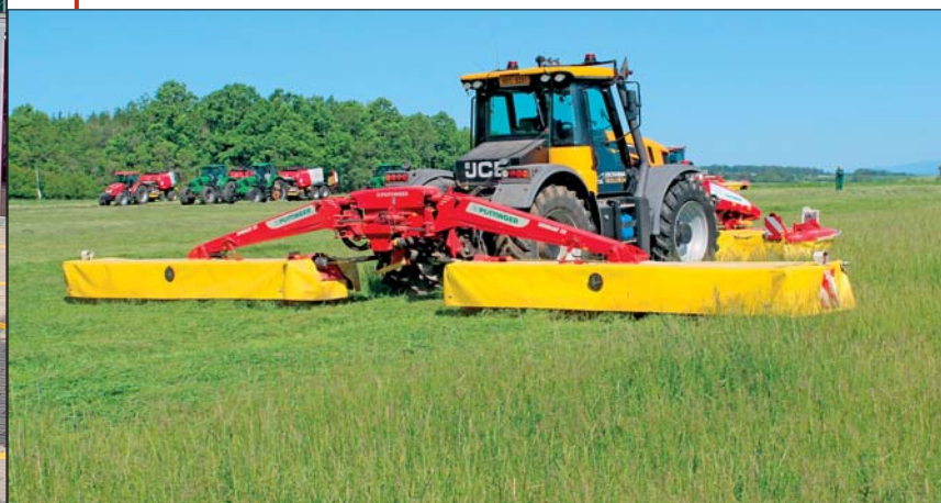
I za jízdy přes velké nerovnosti si žací kombinace Pöttinger NovaCat S12 a čelně nesený žací stroj NovaCat 351 Alpha Motion Pro stále udržovaly kontakt s povrchem pozemku
