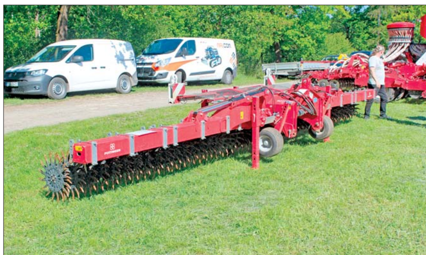
Hlavním způsobem využití kultivátorů Rotocare V firmy Pöttinger je provzdušnění příliš vlhké půdy nebo rozbití půdního škraloupu u vyschlých půd
