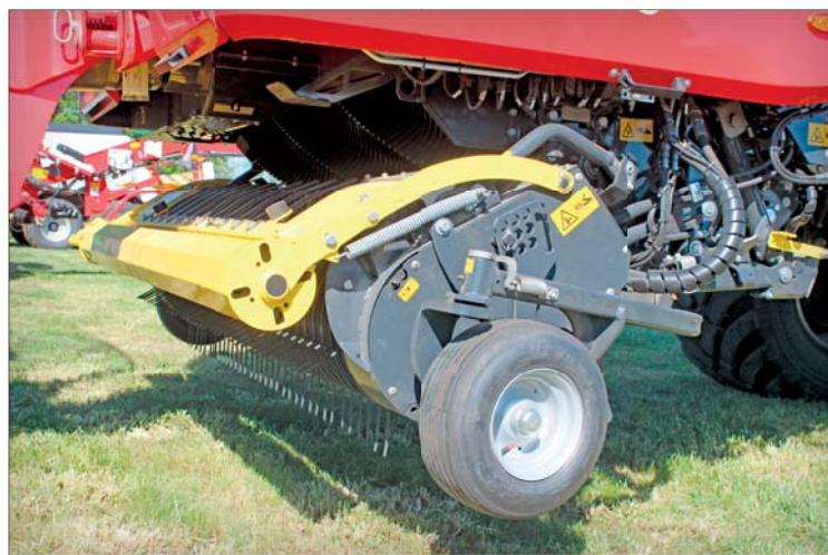
Pro plynulý tok píce od sběrače vozu Jumbo 8000 do rotoru se automatický systém stará o konstantní průřez dopravního kanálu – vyrovnáváním odchylek přizvedáváním kloubové oje
