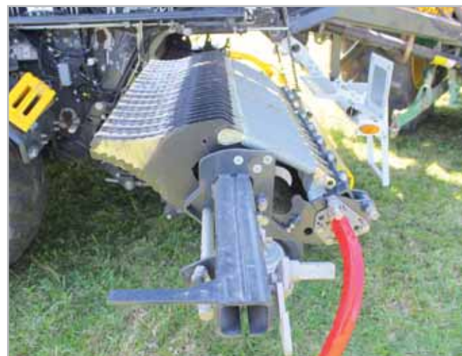
Pokud jsou všechny pružiny nahoře, znamená to, že v pracovní poloze je plný počet nožů. U lisů Impress to je 32 nožů v roztečích 36 mm, díky čemuž se v praxi běžně lisují balíky zavadlé hmoty o průměru 150 cm a hmotnosti přes 1000 kg
