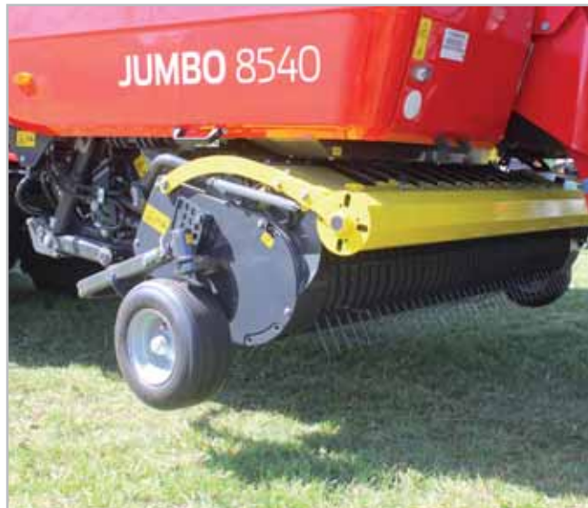
Sběrač návěsů Pöttinger Jumbo 8000 je dostatečně široký na to, aby sklídl i široké řádky a nezanedbával ležet hmotu na poli ani při projíždění zatáček. Pro co nejčistší práci prstů je hydropneumaticky odpružený
