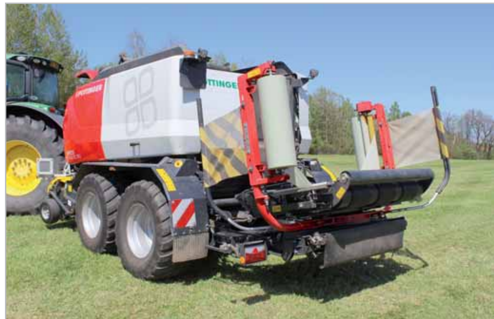
Prezentovaný lis Impress 3160 VC Pro byl vybaven možností vázání do fólie. Po vyklopení balíku z lisovací komory a předání na stůl ovíječky si obsluha může zvolit, zda si přeje balíkem nejprve poněkud pootočit. Přitom dojde k tomu, že „cop“ vázací fólie je pevně přitlačen k obvodu balíku
