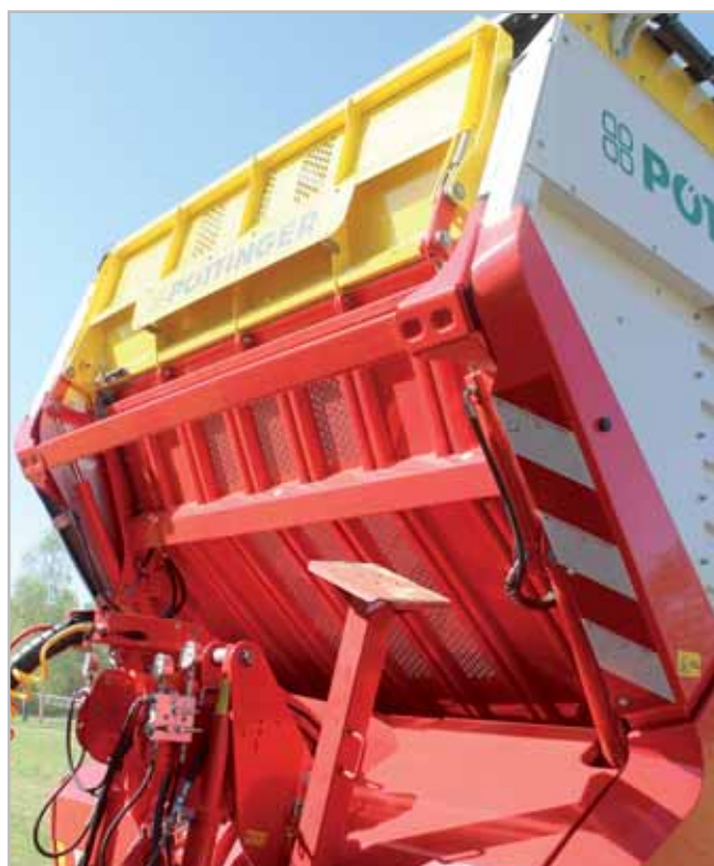
Při sběru píce z řádku vozem Pöttinger Jumbo 8540 je přední stěna ve svislé nakládací poloze. Pokud vůz dosáhne plného zatížení zadní stěny, vyklápne se přední stěna dopředu do koncové polohy, čímž se vytvoří maximální kapacita ložného prostoru
