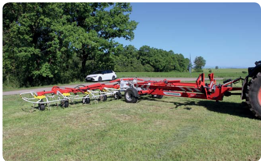
Tažený obrabeč Pöttinger HIT 10.11 T je vybaven deseti rotory a disponuje pracovním záběrem 10,6 m. Každý rotor má osm ramen
