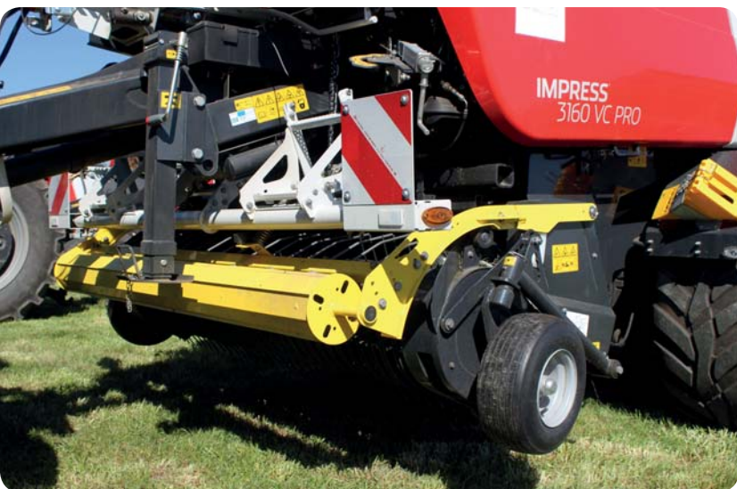
Lis Pöttinger Impress 3160 VC Pro má řízený sběrač s výkyvným uložením pro precizní kopírování půdy. Sběrač má vysokou hltnost
