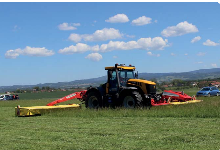
Žací kombinace Pöttinger NovaCat S12 je standardně vybavena systémem hydraulického odlehčení. Úroveň přítlaku si tak lze nastavovat plynule z kabiny
