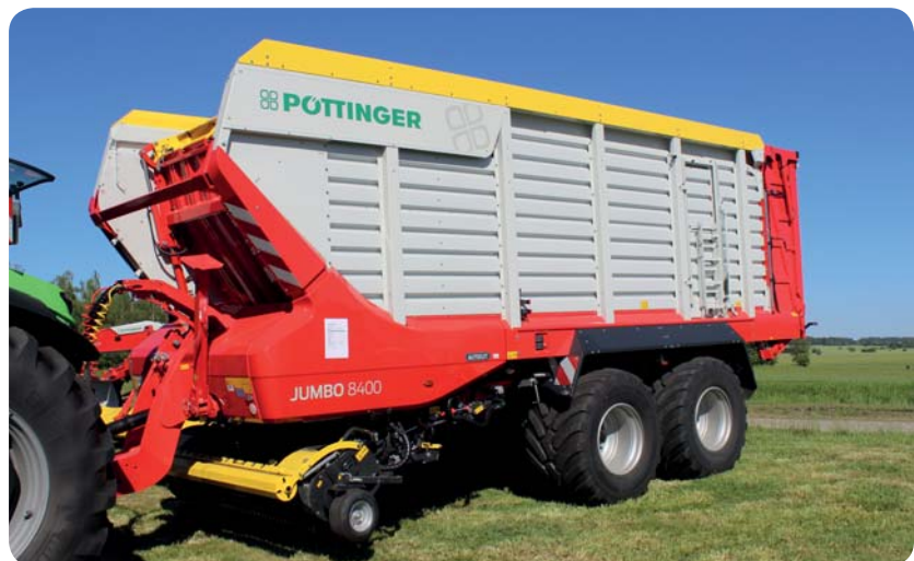
Pokud je podlahový dopravník vozů Jumbo 8000 ovládaný automatickým režimem, napomáhá lepšímu využití ložného prostoru návěsu přední stěna. Ta automaticky pící uvnitř stlačí a poté se automaticky přesune zpět do čelní polohy pro plnění
