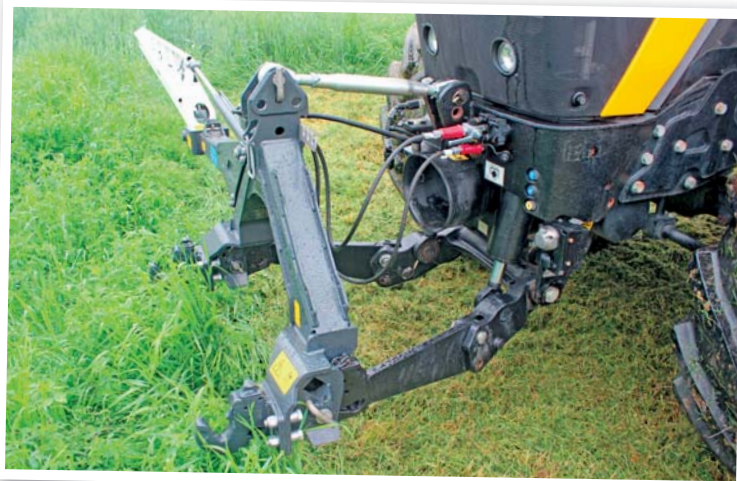
Tento trojúhelník slouží jako závěs pro sensorovou lištu. Sensosafe (pro jednu nebo i obě strany v případě trojkombinace). Dále je zapotřebí už jen dvojitá řídicí jednotka vpředu a napájecí zdroj 12 V. Do háků trojúhelníku lze zavěsit čelně nesený žací stroj, který má vlastní sensorovou lištu
