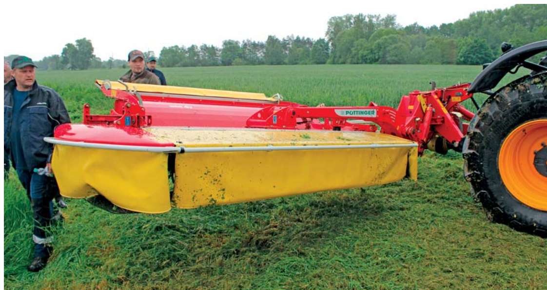
Vzadu bočně nesený žací stroj Pöttinger NovaCat 302 ED se vyznačuje lehkostí a stabilitou. Ovládá se pomocí vnějších hydraulických okruhů a při práci je zvedací válec v plovoucí poloze
