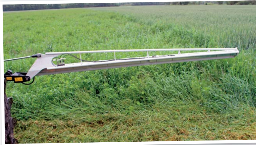
V sensorové liště Sensosafe 300 se nacházejí tři různě široké moduly. V nich jsou uloženy vysílače světelného záření, a dále i přijímače, které přijímají odražené paprsky. Informace jsou odesílány na ovládací terminál v kabině, který je vyhodnocuje
