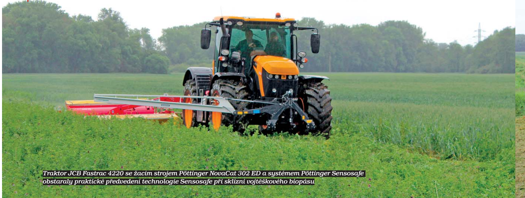
Tento trojúhelník slouží jako závěs pro sensorovou lištu. Sensosafe (pro jednu nebo i obě strany v případě trojkombinace). Dále je zapotřebí už jen dvojitá řídicí jednotka vpředu a napájecí zdroj 12 V. Do háků trojúhelníku lze zavěsit čelně nesený žací stroj, který má vlastní sensorovou lištu
