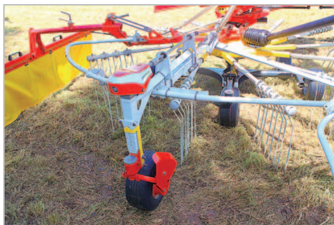
Nové čelní kopírovací kolečko Multitast se nastavuje samočinně spolu s rotorem. Možnost manuálního nastavení kolečka pomocí kliky ale stále zůstává. O aktuálním nastavení informuje uživatel nová stupnice
