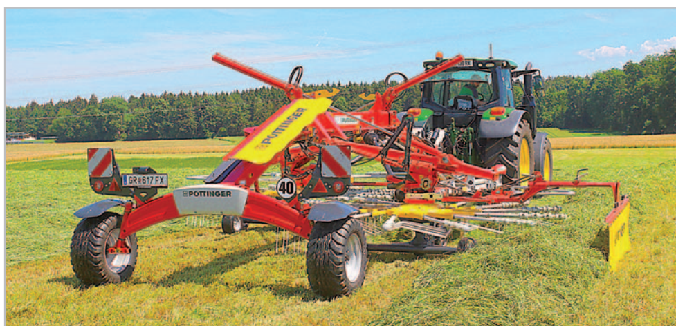
Nový shrnovač Top VT 6820 S je nástupcem oblíbených dvourotorových stranových shrnovačů firmy Pöttinger. Umí formovat buď jen jeden velký stranový, anebo dva menší řádky
