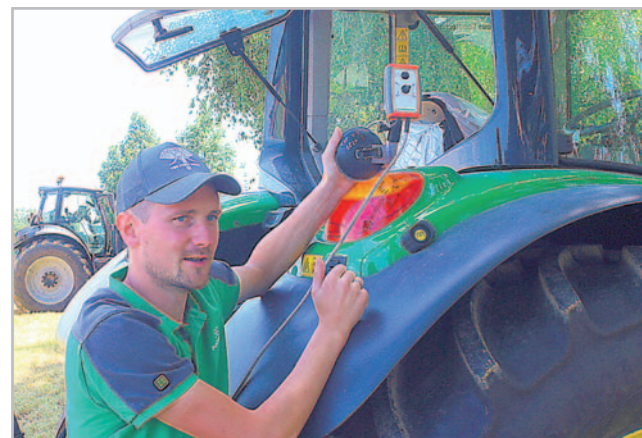
Zástupce firmy Pöttinger drží v ruce přísavku s novým ovládáním, které nahrazuje dosavadní transportní zajištění pomocí lanka. Ovládání se uchytí k traktoru a poté se požadované funkce zvolí přepínačem
