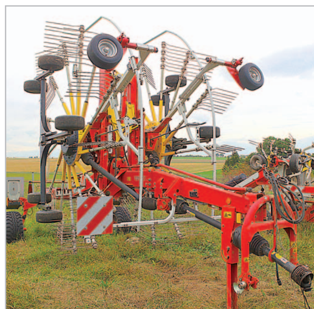
Hospodáři v podniku SVOM mají v oblíbě shrnování shrnovači Pöttinger. Tím aktuálně využívaným dvourotorovým shrnovačem se středovým ukládáním hmoty je TOP 842 C. Pětikolové podvozky rotorů jsou doplněny předním kopírovacím kolečkem Multitast pro čisté shrnování bez příměsí
