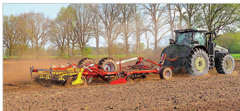
Tažený radličkový kypřič Pöttinger Terria 4040 se úspěšně ujal role stroje pro základní zpracování půdy nejen pro ozimy, ale i pro jařiny. Pozdní podzimní kypření provádí bez opěrného válce
