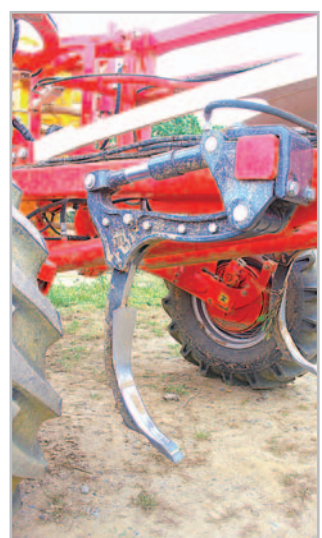
Kypřič Pöttinger Terria 4040 je osazen úzkými dláty a kypří půdu do hloubky 22 cm. I v místech s výskytem velkých objemů posklizňových zbytků je možné pracovat plynule. Systém plynohydraulického jištění je nastavitelný
