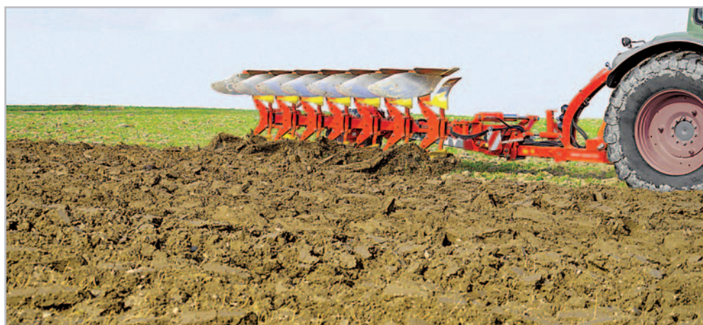
Aktuální model Servo T 6000 Nova je již druhou generací polonesených pluhů od firmy Pöttinger ve společnosti SVOM. V proměnlivých půdních podmínkách a ve svažitém terénu přijde vhod systém trakčního posilovače Traction Control
