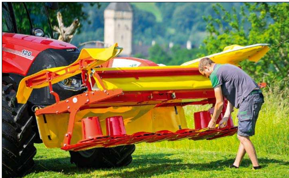
Čelne nesené diskové žacie stroje NOVACAT F. Sklopiteľné čelné kryty pre veľmi ľahkú prístupnosť k pracovným orgánom.
