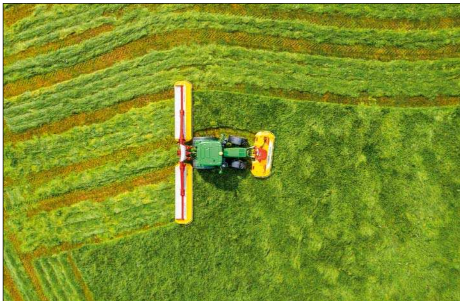
NOVACAT F 3100 OPTICURVE - bočný posuv čelného žacieho stroja zaručuje optimálne prekrytie so zadne neseným žacím strojom, napríklad pri zatáčaní.
