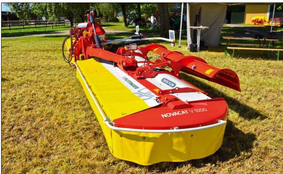
NOVACAT V 9200 CF umožňuje variabilné odkladanie pokosenej hmoty krmoviny do riadku, plošne alebo kombinovane.
