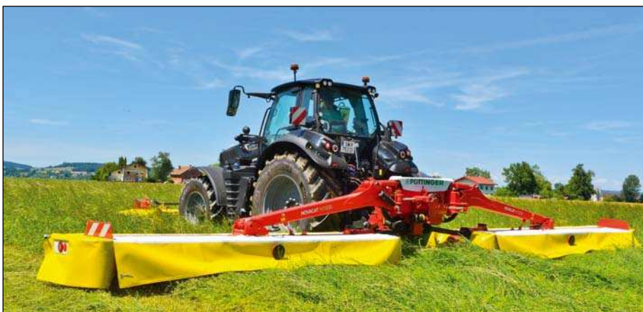
NOVACAT H 11200 s pracovným záberom až 11,14 m. Napriek veľkému pracovnému záberu postačuje agregácia len so 160-koňovým traktorom.
