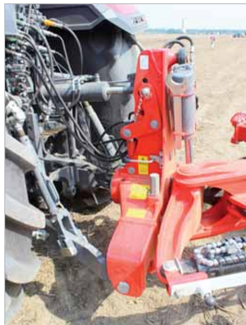
Trakční posilovač Traction Control je osvědčeným řešením pro cílené dotížení nejen brázdového, ale hlavně záhonového kola zadní nápravy traktoru. Při orbě v režimu on-land se systém deaktivuje Foto Petr Beneš
