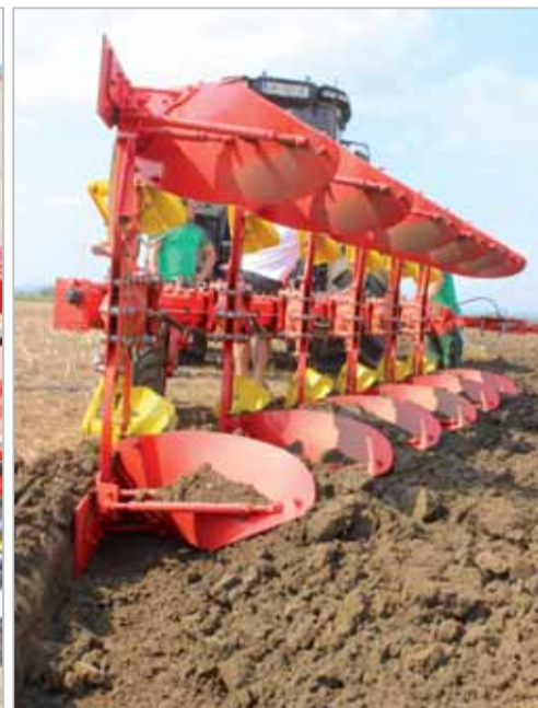
Při orbě na střední půdě do hloubky 23 cm předvedl pluh Servo 4000 Nova kvalitní zaklopení organické hmoty i drobení ornice. Traktor byl za jízdy vedený RTK navigací Foto Petr Beneš
