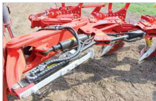
Servo 4000 on-land má provedené úpravy tak, aby bylo možné z kabiny traktoru provádět přestavení mezi režimy jízdy v brázdě a mimo brázd. Robustní konstrukci nezapře Foto Petr Beneš
