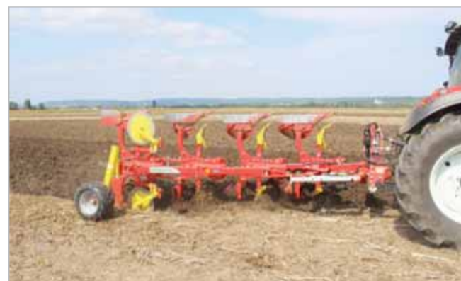
Pluhý nové řady Servo 2000 jsou lehké a díky tomu vhodné k agregacím s traktory výkonové třídy 100 k. Pracovat ale dokážou také velmi dobře Foto Petr Beneš
