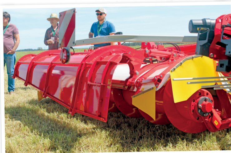
Možné je i jen jednu klapku otevřít a druhou zavřít, pak kombinace provádí kombinované odkládání hmoty
