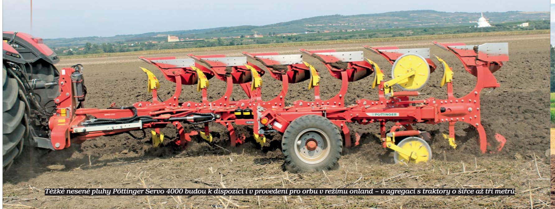
Při orbě na střední půdě do hloubky 23 cm předvedl pluh Servo 4000. Nova kvalitní zaklopení organické hmoty i drobení ornice
