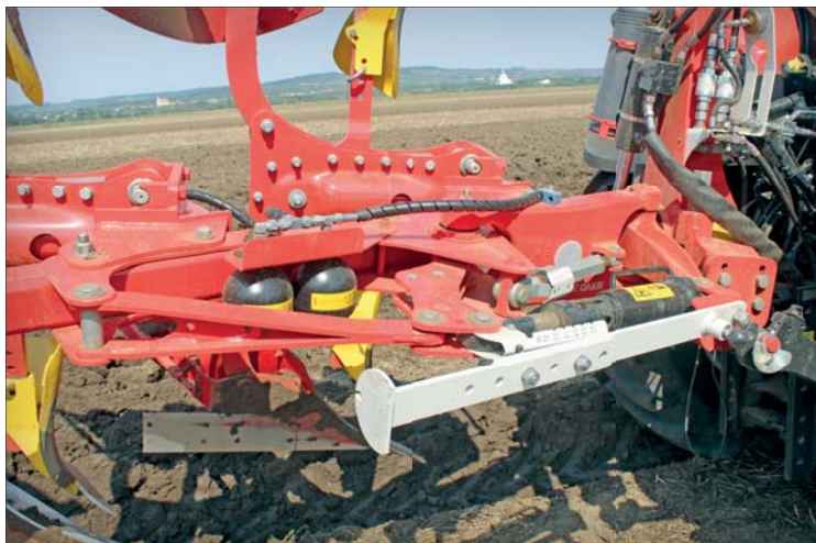
Nastavovací centrum Servomatic se čtyřkloubovou kinematikou bylo u pluhů řady Servo 2000 optimalizováno. Dovoluje snadné přizpůsobení pluhu rozličným traktorům
