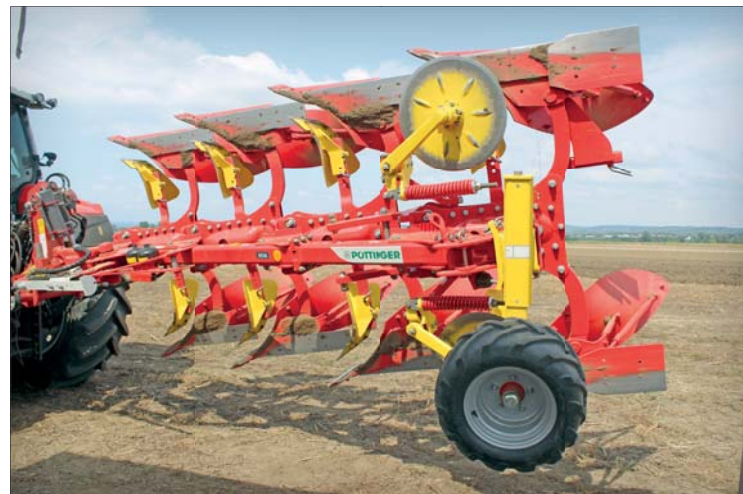
Pluhy nové řady Servo 2000 budou vyráběny jako tří- nebo čtyřradličné. K dispozici je též osvědčené hydraulické non-stop jištění proti přetížení Nova (označení Servo 2000 N)
