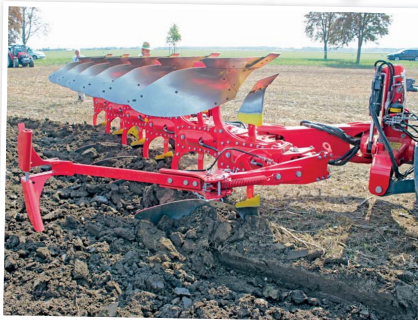
Při orbě na střední půdě do hloubky 23 cm předvedl pluh Servo 4000. Nova kvalitní zaklopení organické hmoty i drobení ornice
