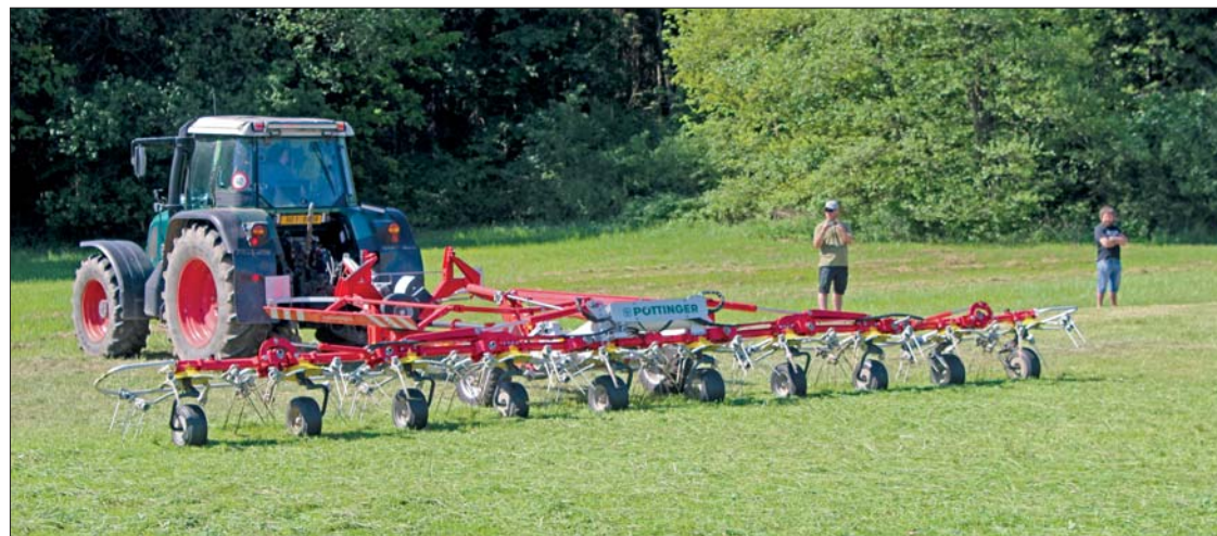
Tažený obraceč Pöttinger HIT 10.11 T s deseti rotory má záběr 10,6 m. Rotory Dynatech manipulují s píci velmi šetrně. Přejezdy mezi pozemky jsou rychlé díky pohodlnému skládání do transportní polohy
