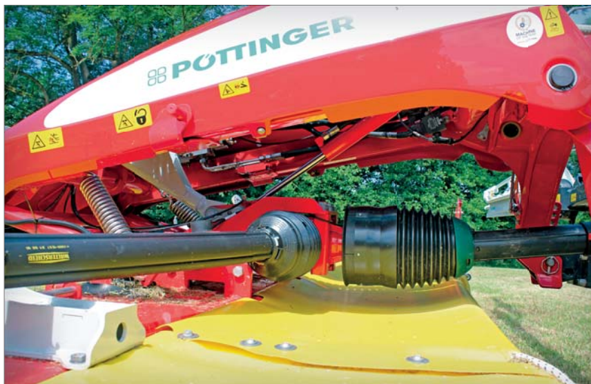
Aktivní nosný rám čelně neseného žacího stroje NovaCat 306 F RC je v reakcích na nerovnosti velmi rychlý. Hydraulický válec pro zdvih do souvratové polohy je integrován v závěsu
