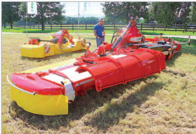
Nová žací kombinace Pöttinger NovaCat V 9200 se systémem Cross Flow boduje nízkou hmotností a sníženou energetickou náročností
