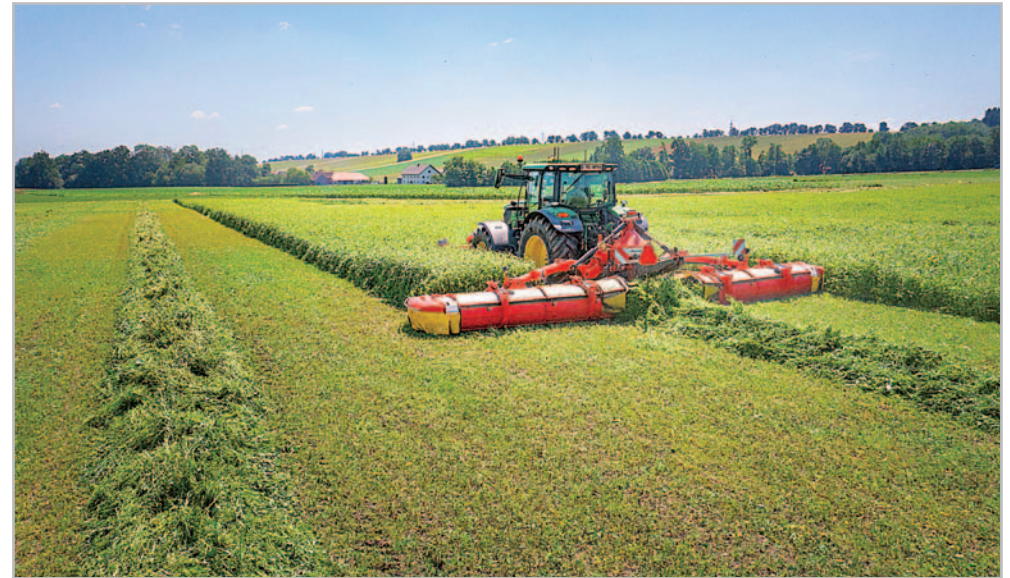
V žací kombinaci NovaCat V 9200 CF se systémem Cross Flow si posečenou hmotu od žacích disků odebírají přímo šnekové dopravníky. Tím, že hmota neprochází přes kondicionér, snižují se ztráty odrolem
