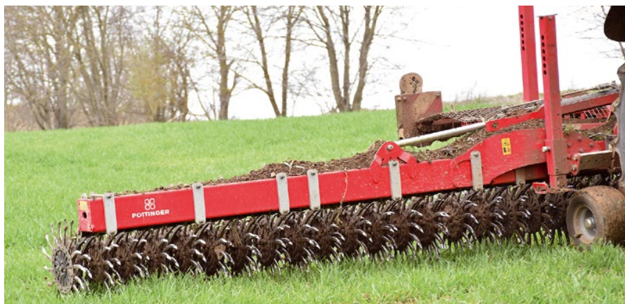
Rotačná plečka ROTOCARE V 8000 s pracovným záberom osem metrov. Má vysokú výkonnosť a vynikajúcu účinnosť pri mechanickej kultivácii plodín.
