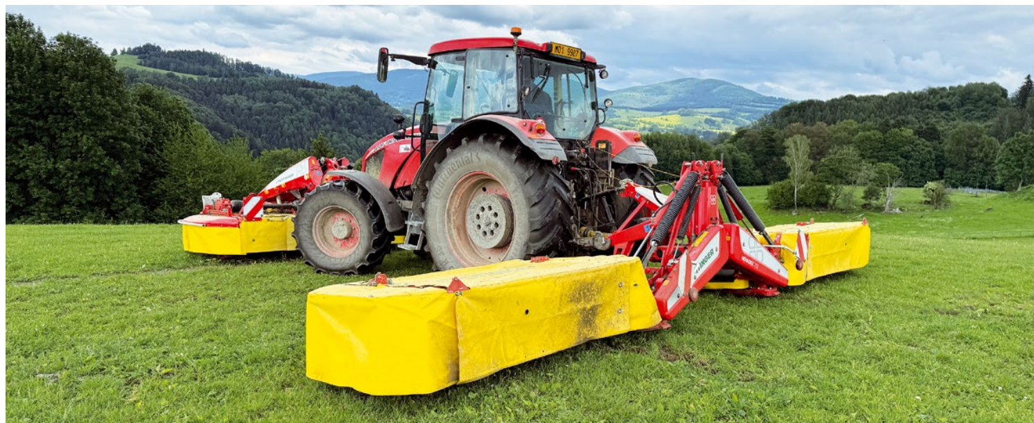
Zadní nesený diskový žací stroj NOVADISC 732 v kombinaci s čelním diskovým žacím strojem NOVACAT 301 ALFA MOTION PRO.
