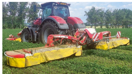
Disková žací kombinace s mačkáčemi válci NOVACAT A10 RCB s čelní lištou NOVACAT 301 ALPHA MOTION RCB PRO.
