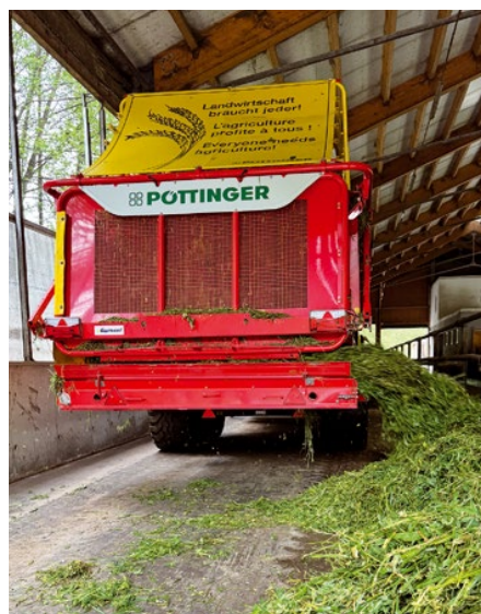
Příčný základací dopravník pro vykládku v průjezdném žlabu se pohodlně ovládá z kabiny traktoru.
