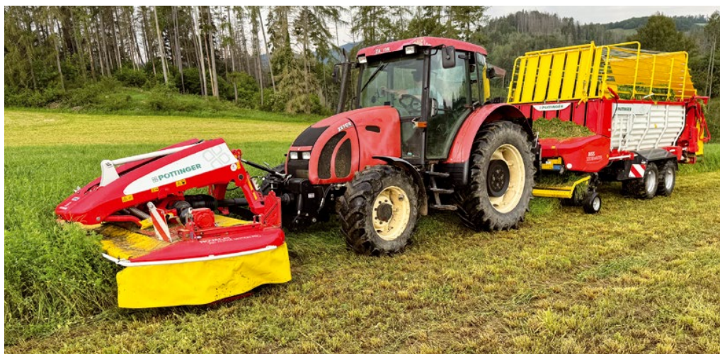
Čerstvou zelenou píci na přikrmování krav sklízí dvakrát denně a přiváží do stáje samosběrací vůz BOSS 3210 DB MASTER s tandemovou nápravou a objemem ložného prostoru 20,5 m³. Porost seče čelní diskový žací stroj NOVACAT 261 ALPHA MOTION PRO s pracovním záběrem 2,62 m.
