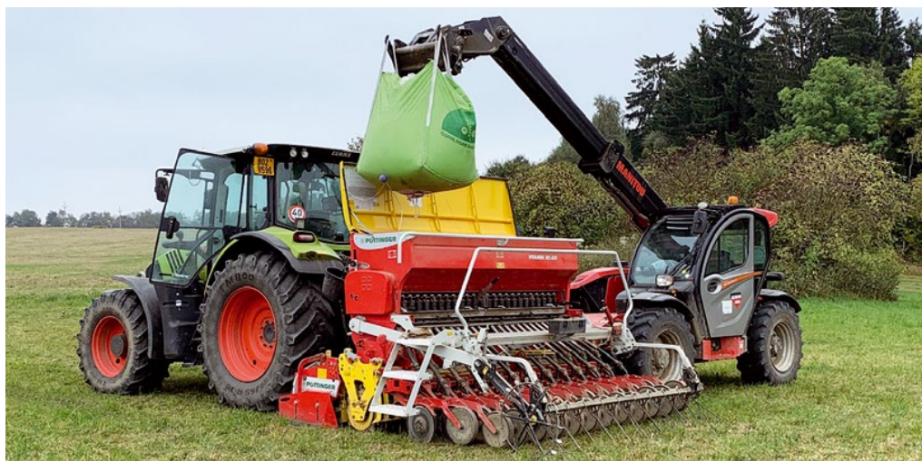
Univerzální mechanický secí stroj VITASEM 302 ADD s dvoudiskovými botkami DUAL DISC a rotačními bránami LION 303.12 spolehlivě zakládá osivo pěstovaných plodin včetně přesevu a obnovy travních porostů.
