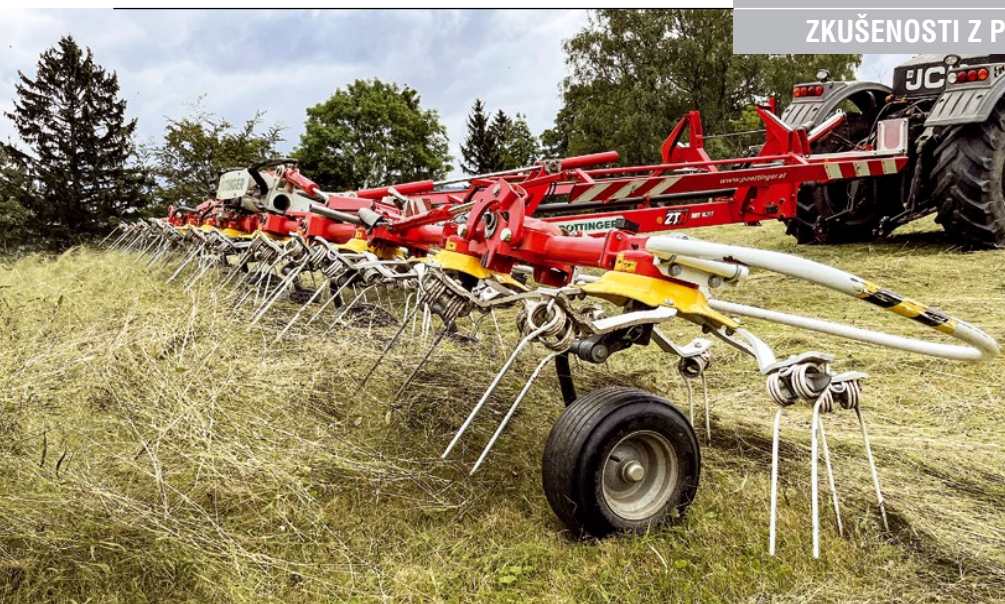
Tažený desetirotorový obraceč HIT 10.11 T s pracovním záběrem 10,60 metru pracuje na farmě třetí sezonu. S traktorem 220 k vychází průměrná spotřeba 2,1 l nafty na hektar a zpracuje 8,7 hektaru za hodinu.
