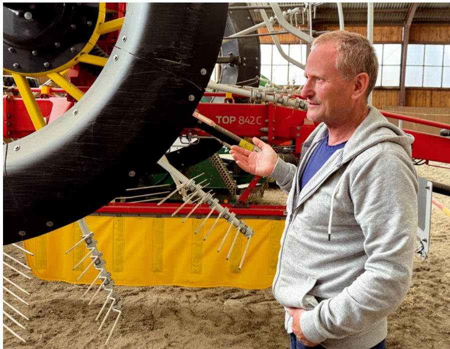
MVDr. Jan Vala je velmi spokojený s dvourotorovým středovým shrnovačem TOP 842 C s originální konstrukcí FLOWTAST, kdy jsou namísto podvozku s pneumatikami kluzké a odolné plazy ve tvaru srpu. Stroj perfektně kopíruje celý povrch pracovní plochy a je to výborné řešení zejména u obtížných a vlhkých pozemků.
