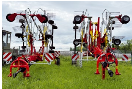
Shrnovače jsou na farmě dva. Starší TOP 762 C slouží jako rezerva. Třetí sezonu zvládá celou výměru dvourotorový středový shrnovač TOP 842 C (vpravo).
