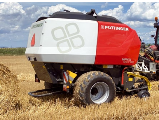
Lis IMPRESS 3160 V PRO s variabilnou lisovacou komorou, ktorý je vybavený viazaním do siete ako i do fólie. Na farme v Salke pracuje druhú sezónu.
