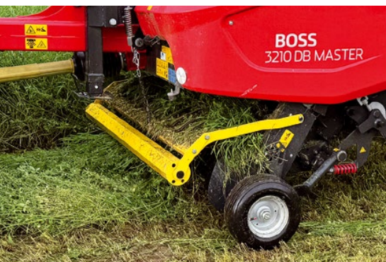
Sklizeň čistého krmiva je jedním z hlavních předpokladů pro dobrý zdravotní stav skotu. Odlehčený sběrač s velkým příčným výkyvem zaručuje perfektní kopírování nerovností a kvalitní sklizeň.
