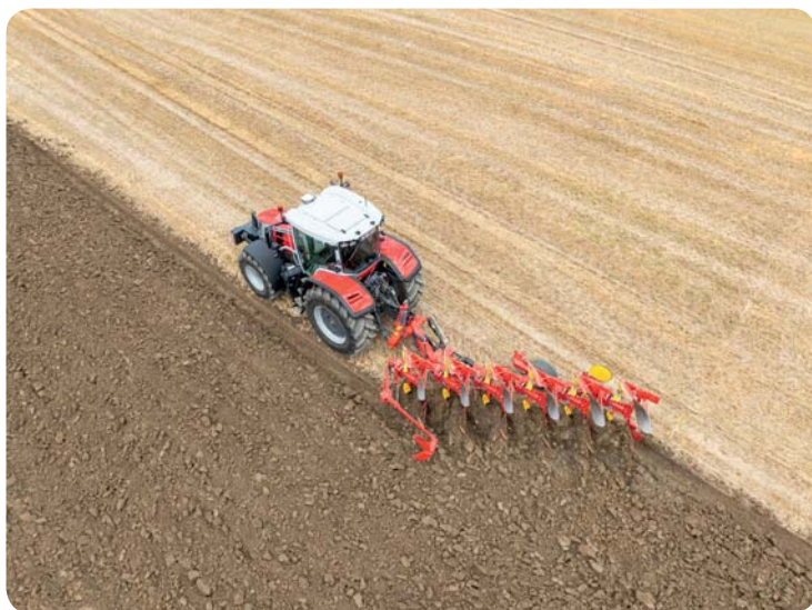
Nový pluh Servo 4000 onland má provedené úpravy tak, aby bylo možné z kabiny traktoru provádět přestavení mezi režimy jízdy v brázdě a mimo brázdou
