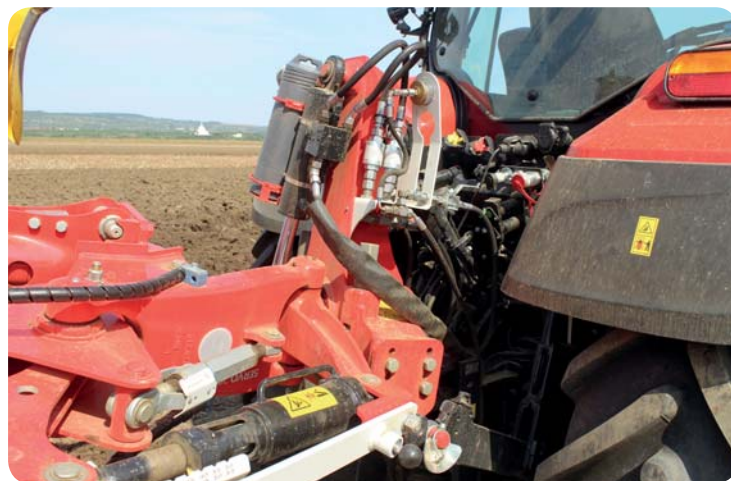
Vystavený pluh Servo 2000 Nova se čtyřmi páry orebních těles prezentoval nově vyřešené nastavování příčného sklonu. Původní vřeteno je vystřídáno komfortnějším otočným šroubem
