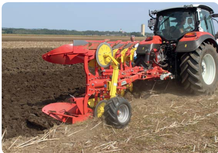
Pluhů nové řady Servo 2000 vůbec poprvé přicházejí s možností plynulého ovládání šířky záběru všech orebních těles z kabiny traktoru pomocí hydrauliky
