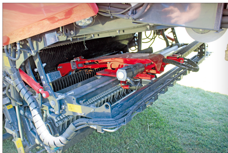
Víceúčelový návěs Pöttinger Jumbo 10010 L Combiline je vybaven brousicím zařízením Autocut. S ním je možné udržovat všechny nože v nabroušeném stavu po celý den stejně jako kvalitu řezanky, zároveň se i snižuje spotřeba paliva
