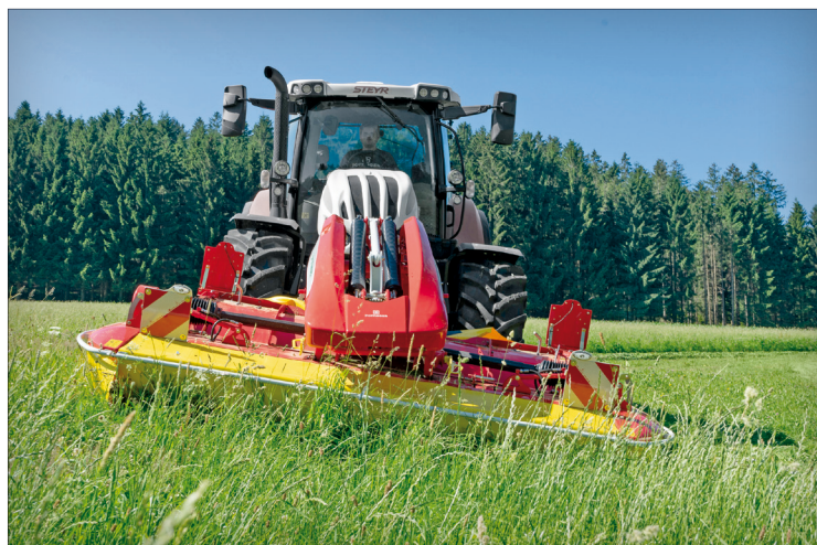
Specifickým znakem pro žací stroje v závěsu alpha-motion je jedinečná kinematika nosného rámu. Přítlak na žací nosník tak zůstává vždy na shodné úrovni a nedochází k poškozování travního drnu
