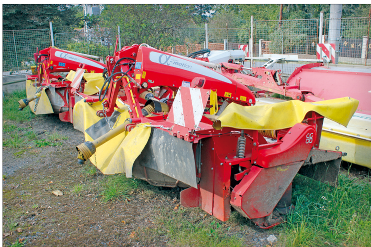
Žací stroje Pöttinger NovaCat Alpha-motion se agregují přímo do předního tříbodového závěsu traktoru. Vynikající kopírování terénu má podstatný vliv na výrazné omezení znečištění píce
