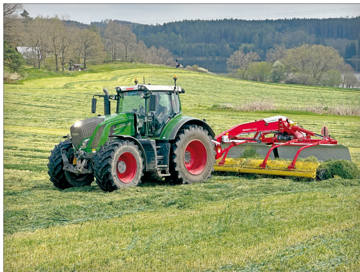
Pásový řádkovač Pöttinger Mergento VT 9220 se osvědčil i při shrnování travní píce na loukách a senážního žita
