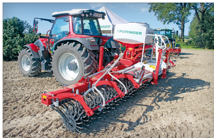
Kultivátory Pöttinger Rotocare V mohou být na přání osazeny kitem pro souběžný přísev či přihnojování, čímž se možnosti využití tohoto stroje ještě rozšíří
