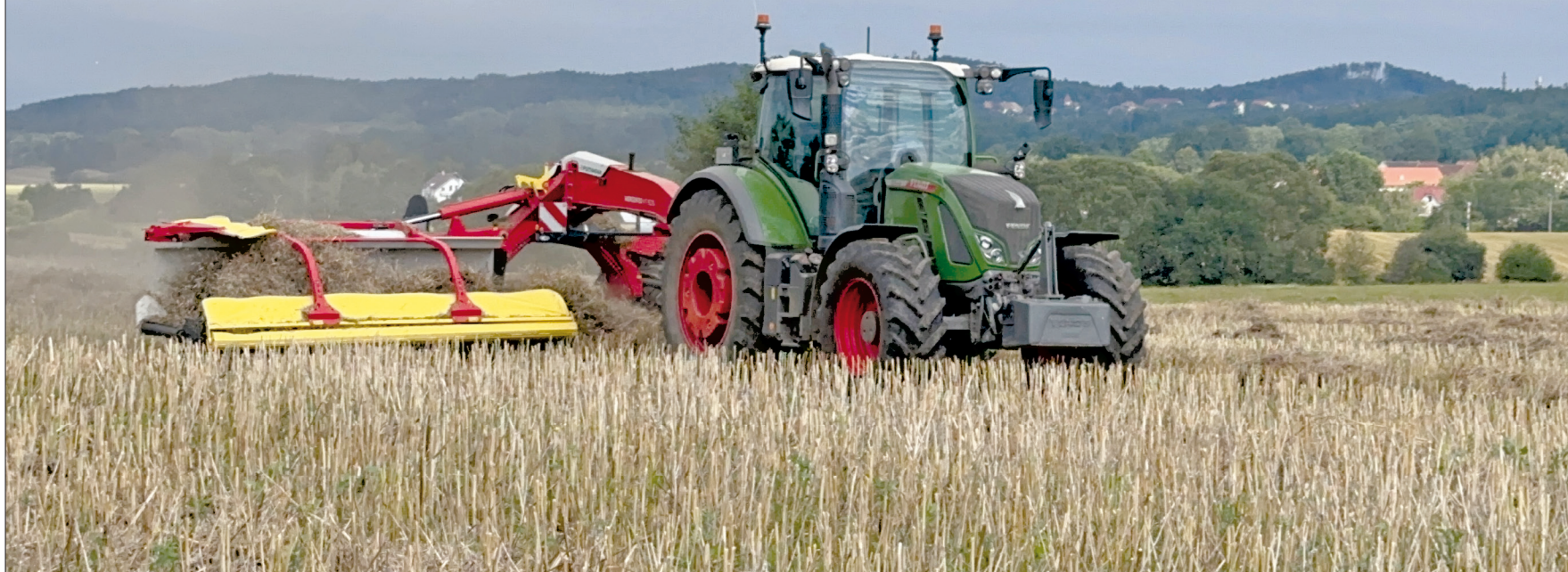
Pásový řádkovač Pöttinger Mergento VT 9220 se s úspěchem využívá i pro obracení a nahrnování slámy z obilovin a olejnin
