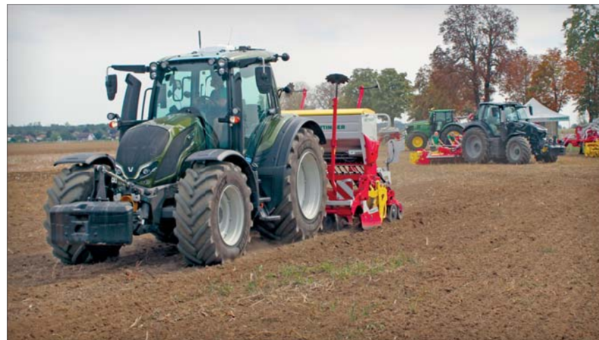
Spolu s mechanickým secím strojem Vitasem M 3000 DD a traktorem Valtra N154 s plynulou převodovkou bylo na Tiskových dnech předvedeno setí do mělce zpracované půdy
