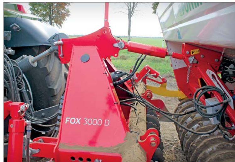
Hydraulicky ovládané horní táhlo tříbodového závěsu je dodáváno na přání
