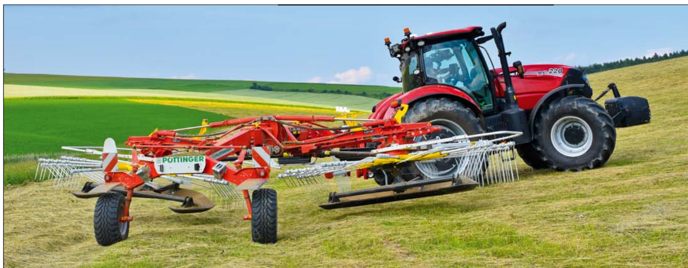
Na úvratí sa stroj zdvíha a otáča pomocou zadnej riaditeľnej nápravy.
