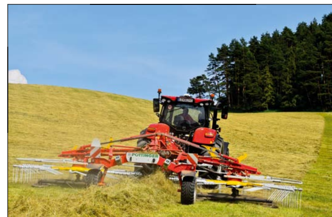
Zhrabovač TOP 882 C FLOWTAST má vyššiu priechodnosť a do riadku zhrnie čistejšiu krmovinu v porovnaní s klasickým zhrabovačom s vodiacími kolesami.
