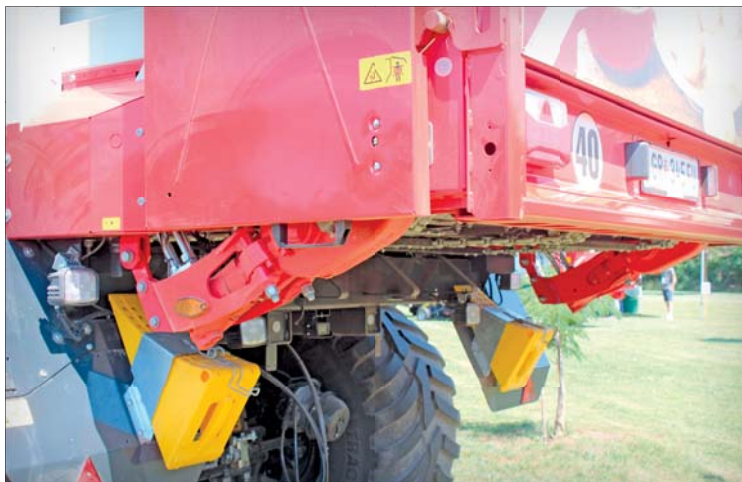
Dva hydromotory pohonu podlahového dopravníku návěsu Jumbo 8470 mají dvě rychlosti pohybu a funkci Boost pro maximální rychlost na konci vyprazdňování ložné plochy
