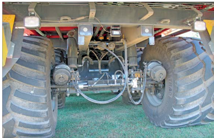
Hydropneumatikou odpružený podvozek návěsu Jumbo 8470 přináší maximální jízdní komfort i bezpečí, zvláště za jízdy ve svahu. Bude doplněn o vážicí zařízení
