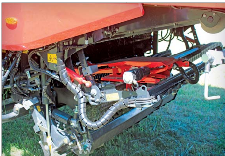
Problémy z důvodu nízké teploty oleje jsou u automatického brousičského zařízení Autocut nové generace minulostí. Zařízení má elektrohydraulický pohon (hydraulicky poháněný brusný kotouč, elektricky poháněné všechny ostatní funkce)
