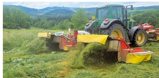
Žací kombinace NOVACAT X8 ED s prstovým lamačem EXTRA DRY a pracovním záběrem 8,30 metru.
