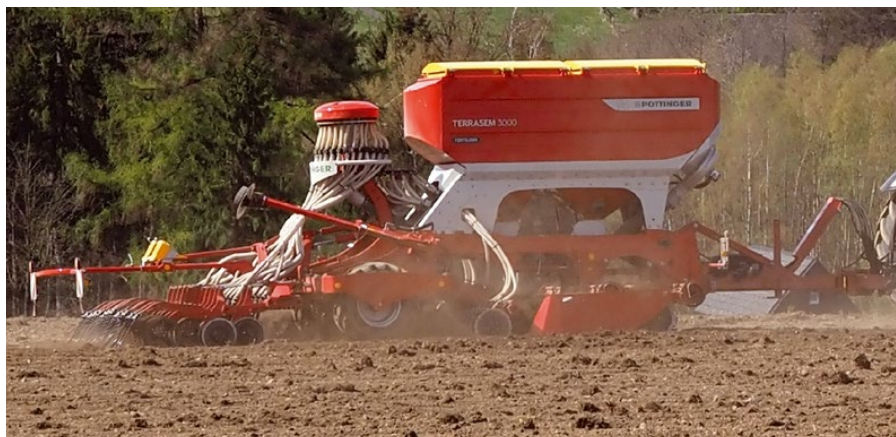
Univerzální pneumatický secí stroj TERRASEM 3000 D Z s pracovním záběrem tři metry je vybavený dvojím dávkováním, které umožňuje současně ukládat při jedné operaci osivo i hnojivo.
