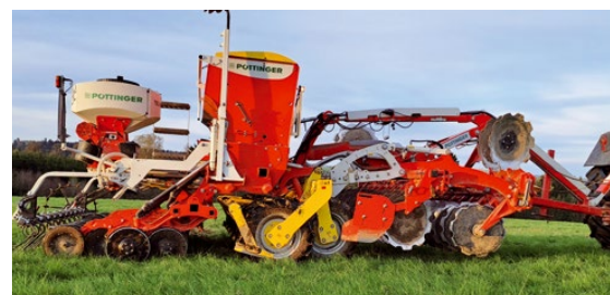
Kombinaci zpracování půdy a setí umožňuje nástavbový mechanický secí stroj VITASEM 302 ADD v agregaci s flexibilním poloneseným diskovým podmítačem TERRADISC 3001 MULTILINE.
