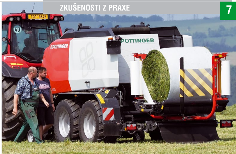
Lis na kulaté balíky s variabilní komorou IMPRESS 3160 VC PRO umožňuje obvodové vázání do fólie a je tak vhodný pro všechny podmínky nasazení, jak pro sklizeň senáže, sena nebo slámy. Nový stroj připravil a předal budoucím uživatelům na farmě v Dobřečově Josef Vlach (vlevo), servisní zástupce firmy Pöttinger pro ČR.
