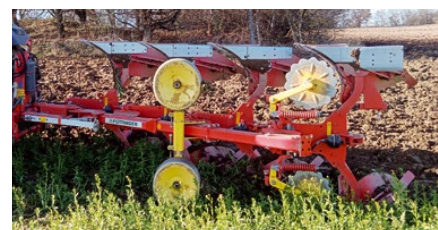
Čtyřradličný pluh SERVO 25 NOVA s hydropneumatickou pojistkou proti kamení a přetížení.
