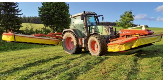
Nejstarší a stále funkční technika Pöttinger na farmě Končiny je žací kombinace, kterou tvoří zadní nesený diskový stroj NOVACAT 350 H a čelní diskový stroj NOVACAT 306 F ALPHA MOTION.
