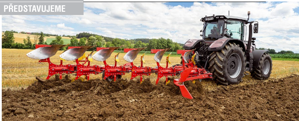
Z orby v brázdě můžete přejít na orbu ON LAND v několika jednoduchých krocích. K tomu slouží přidavné rameno ON LAND pro posouvání rámu směrem ven. Pluh lze proto agregovat i s traktory do vnější šířky 3 m.
