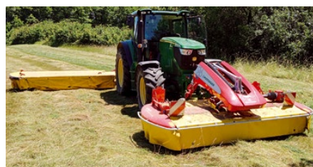
Žací kombinaci s pracovním záběrem šest metrů tvoří zadní diskový žací stroj NOVADISC 350 a čelní diskový žací stroj NOVACAT 301 ALPHA MOTION PRO.
