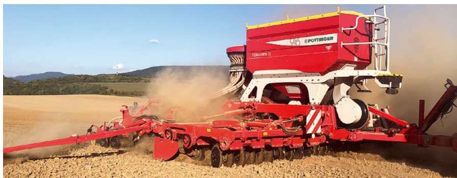
Univerzálny sejací stroj TERRASEM C6 kombinuje pracovné kroky prípravy osivového lôžka s opätovným utužením a sejbou pri jednom prejazde. V RD Tekovské Nemce bude tento rok pracovať piatu sezónu.
