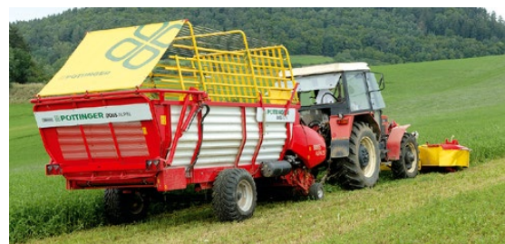
Samosběrací vůz BOSS ALPIN 251 se žacím strojem NOVACAT 261 CLASSIC od jara do podzimu sklízí vojtěšku na zelené krmení dojníc.
