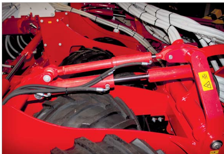
Dvojitý hydraulický válec na obrázku nahoře slouží pro nastavení hloubky uložení osiva, pod ním pak se vpravo ovládá přítlak na secí botky a vlevo pak zvedání na souvratích
