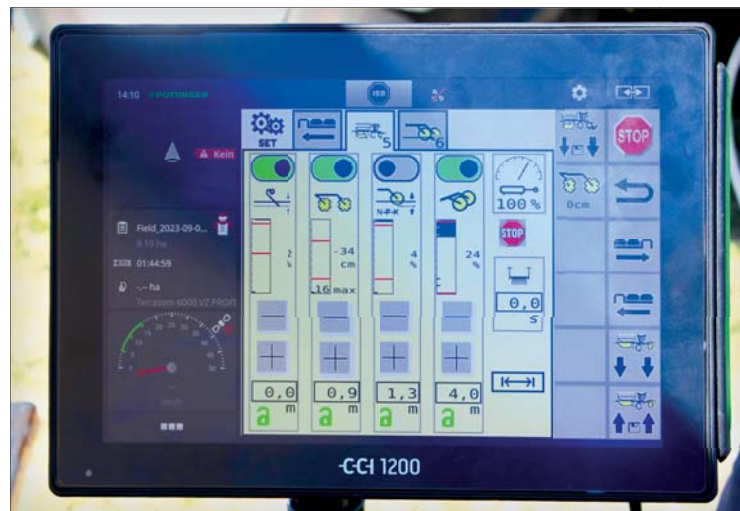
Nové komfortní ovládání Profiline přináší možnost samostatného ovládání jednotlivých pracovních sekcí secího stroje na ISOBUS terminálu
