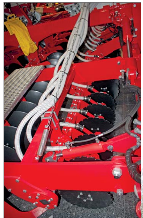
Secí jednotka s bezúdržbovým uložením před pneumatikovým válcem může sloužit nejen k uložení hnojiva, ale i osiva – vždy mezi řádky, setí secími botkami
