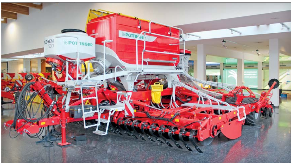
Možnost setí až tří plodin najednou či souběžného setí s přihnojením zvyšuje produktivitu práce se stroji Terrasem V Z a setří čas i náklady
