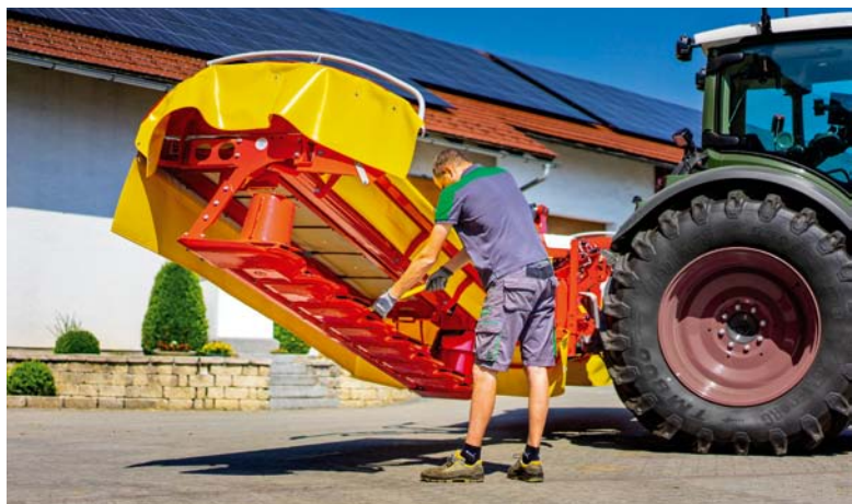
Dokonalý prístup k žacej lište pre rýchlu a jednoduchú výmenu nožov.
