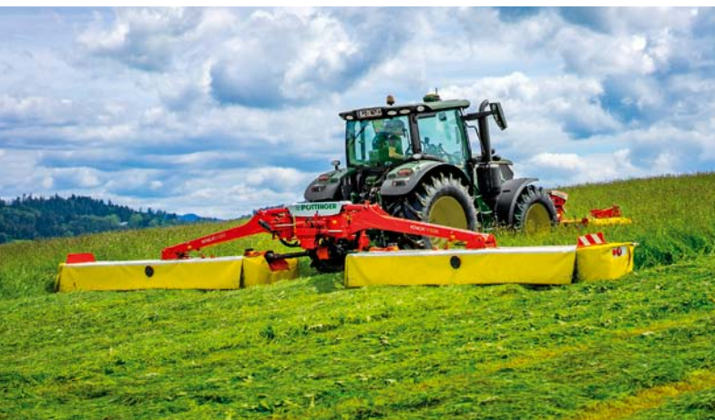
Disková žacia kombinácia NOVACAT H 11200 s pracovným záberom až do 11,14 m.
