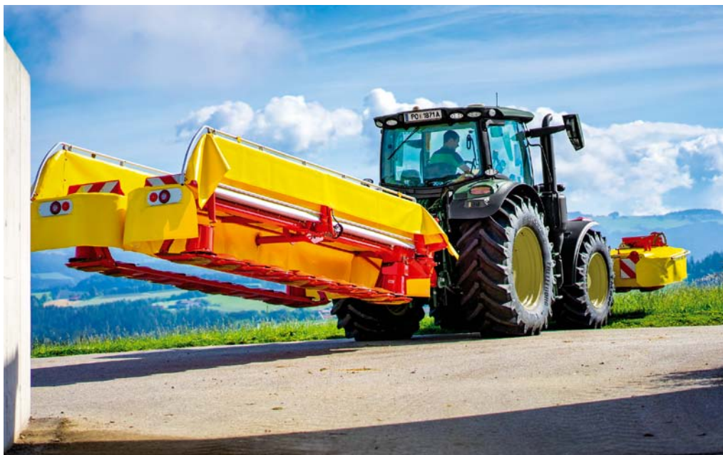
Transportná poloha s automatickým sklopením ochranných krytov pre malú transportnú šírku a dokonalý spätný výhľad.
