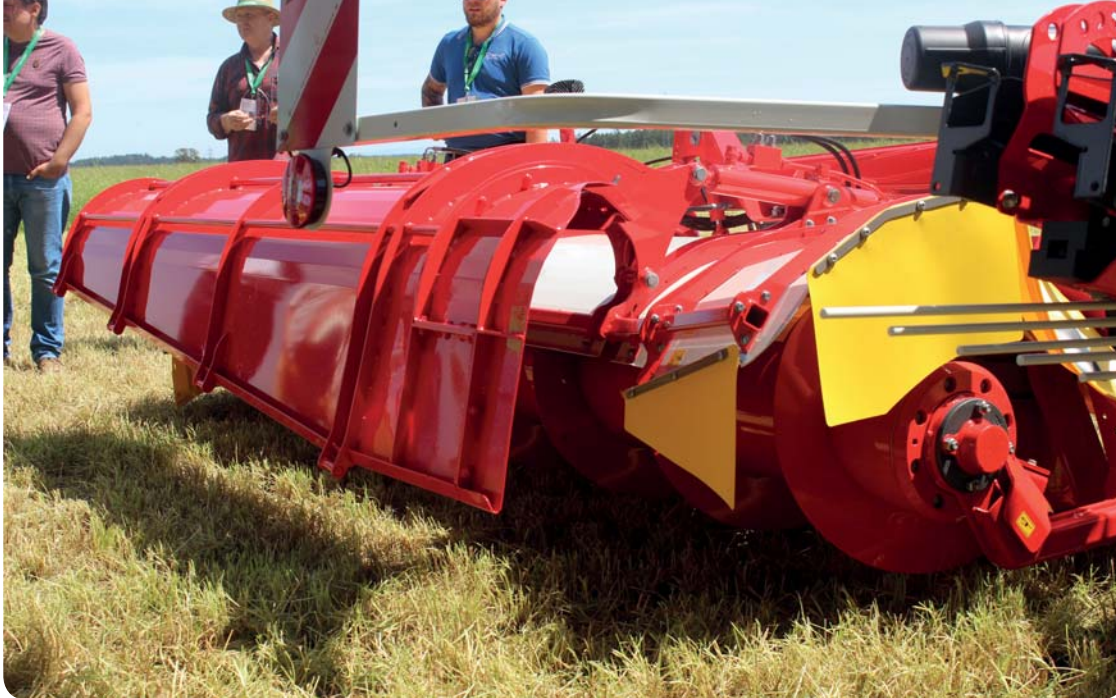
V žací kombinaci NovaCat V 9200 CF se systémem Cross Flow si posečenou hmotu od žacích disků odebírají přímo šnekové dopravníky. Tím, že hmota neprochází přes kondicionér, snižují se ztráty odrolem
