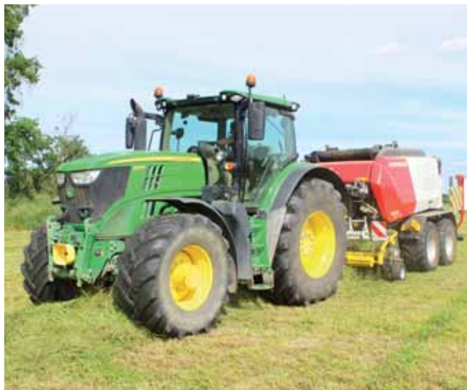
Při sklizni zavadlé travní píce se zvýšenou vlhkostí na poloviční počet 16 nožů činila spotřeba paliva 14 až 15 litrů za hodinu Foto Petr Beneš
