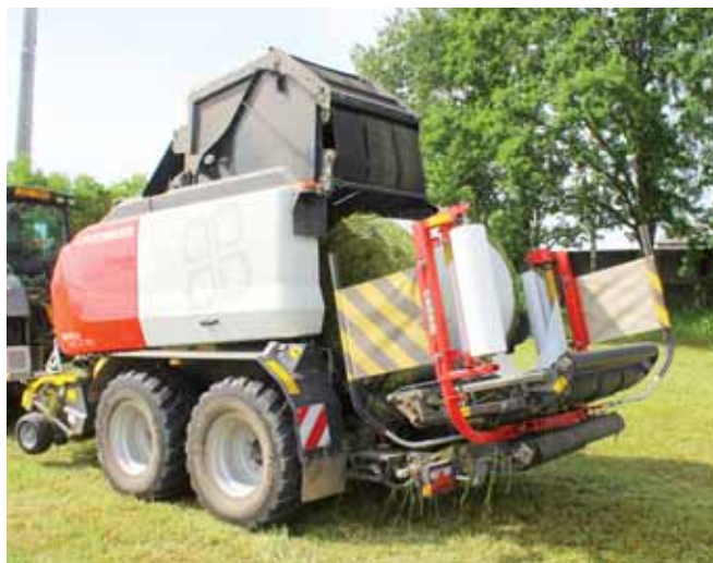
Balík, zavázaný po obvodu do fólie, je automaticky vyklopen z lisovací komory a předán na stůl ovíječky. V dalším kroku si obsluha může zvolit, zda si přeje balíkem nejprve poněkud pootočit a jak dlouho má toto pootočení trvat Foto Petr Beneš
