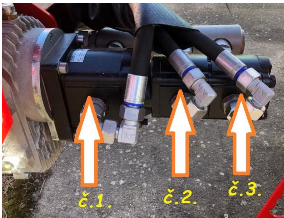
Obr. 6 - Sběrače i příčné dopravní pásy jsou poháněny hydraulicky. Olejové čerpadlo sestávající ze tří jednotek umožňuje nezávisle ovládat sběrací ústrojí a levý i pravý příčný dopravníkový pás. Olejové čerpadlo je umístěno přímo na vstupním rámu. Kardanová hřídel jede vždy v přímém směru, a to i v zatáčkách. Hydraulické olejové čerpadlo je poháněno otáčkami 540 ot./min. V zájmu úspory paliva je možný provoz s 540 E a se sníženými otáčkami motoru.
