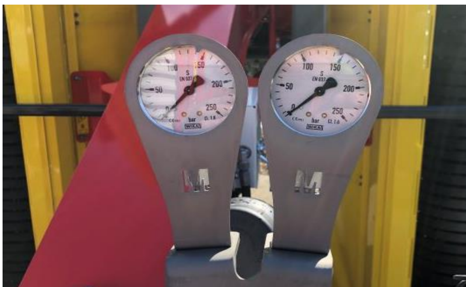
Obr. 9 - Zobrazení odlehčovacího tlaku pásových jednotek. Šipka na tlakoměru ukazuje doporučenou hodnotu cca 150 bar.
