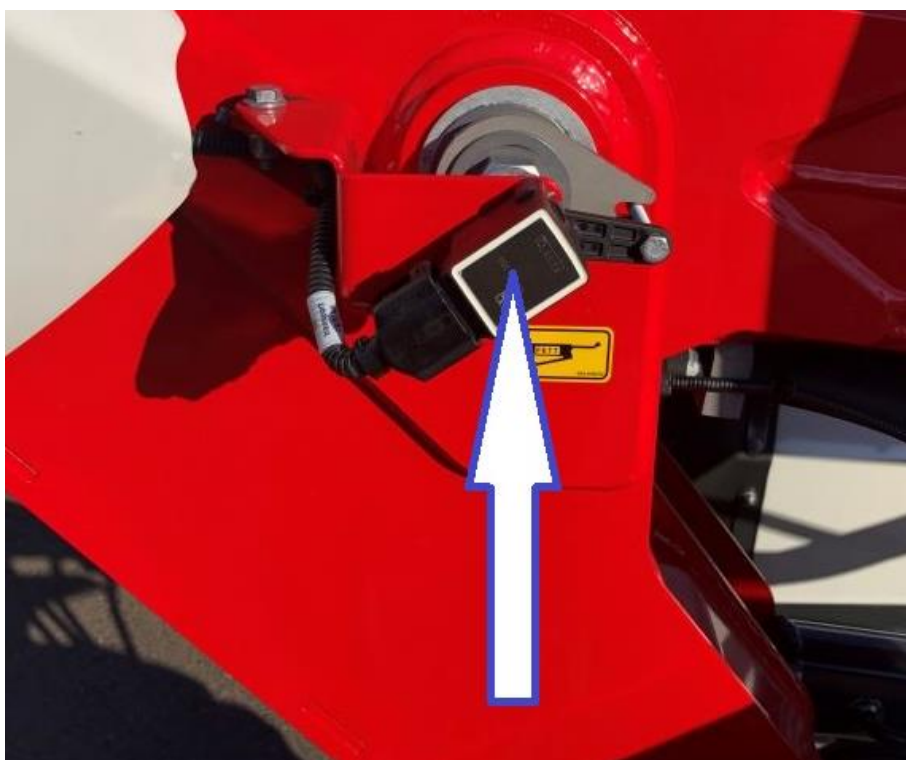
Obr. 17 - Úhlový senzor pro polohu ramen B8 vpravo, B7 vlevo.
