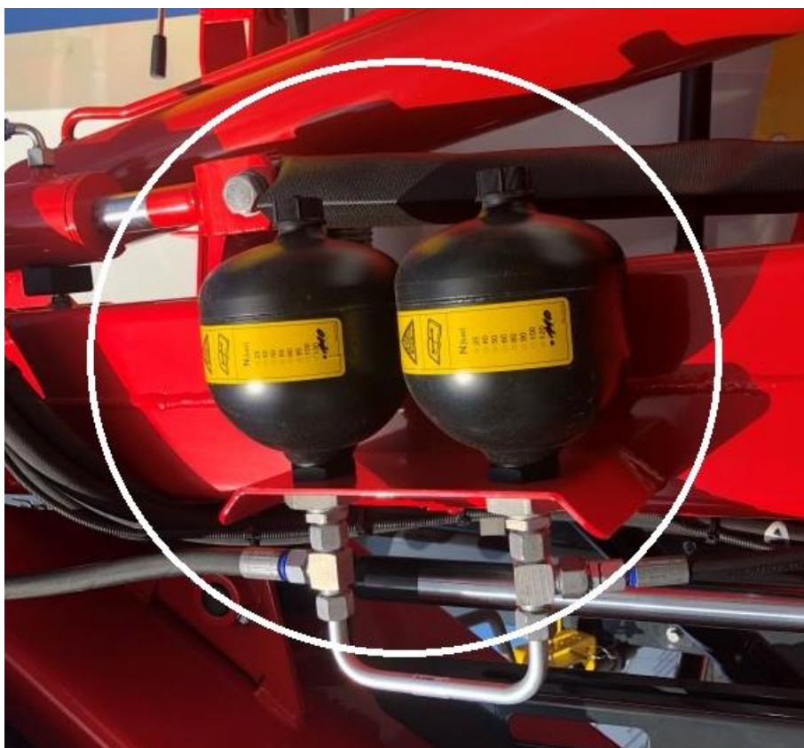
Obr. 13 - Akumulátory odlehčení pásových jednotek.
