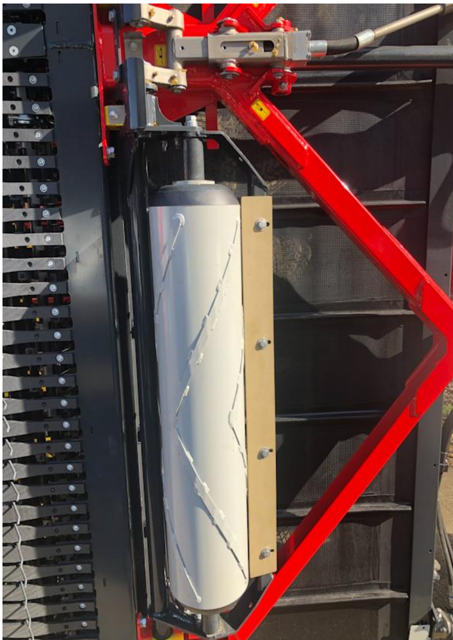
Obr. 27 - Opěrné válečky – jedinečné kopírování nerovností.
