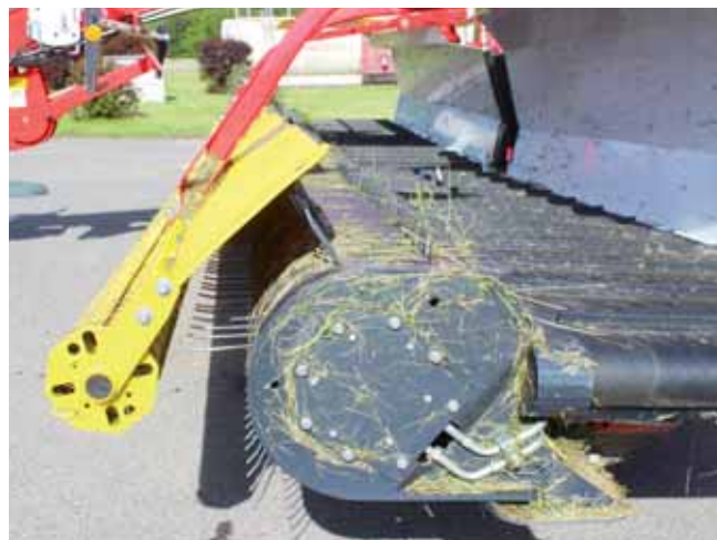
Řízený sběrač má poměrně velký průměr a šest řad prstů. Pokud by hmota měla tendenci od sběrače odskakovat dopředu, pak ji spolehlivě vrátí k prstům přítlačné válečky
