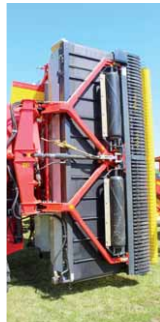
K čistotě práce přispívá i fakt, že pojezdové válečky se nacházejí v blízkosti záběru prstů sběrače a zaručují tak pro celý řádkovač ideální kopírování terénu
