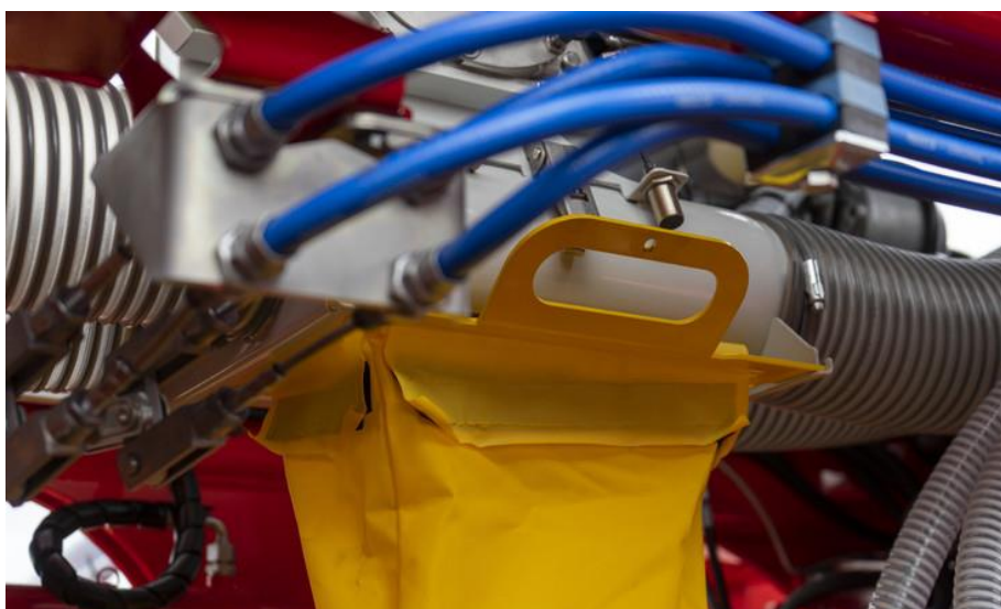
Umístění kalibračního pytlíku pro zkoušku výsevku.
