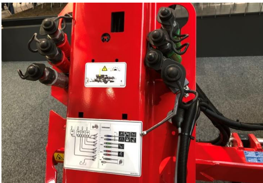
Hydraulické hadice a schéma zapojení hydraulických hadic.
