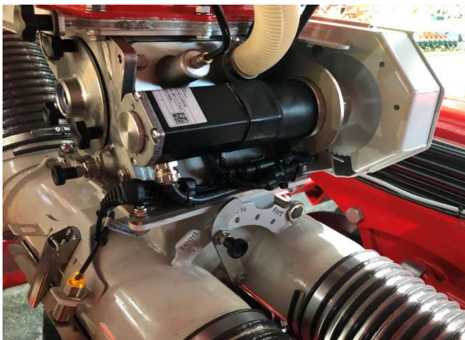
Pohon výsevního válečku elektomotorem.
