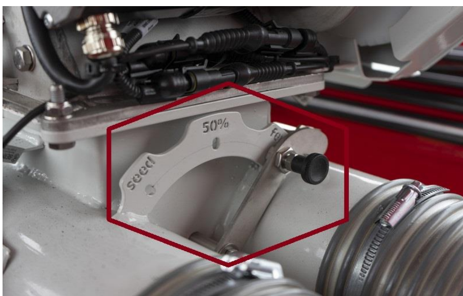
Umístění kalibračního pytlíku pro zkoušku výsevku.
