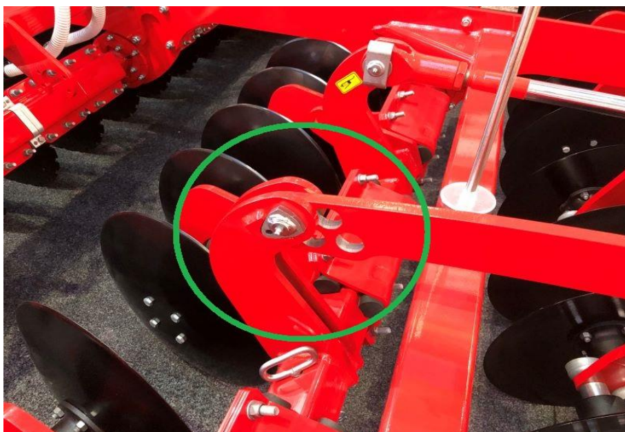
Seřízení roviny mezi přední a zadní řadou disků přípravy půdy.
