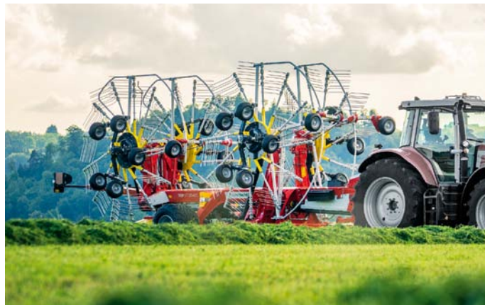
TOP VT 12540 C pri preprave po cestných komunikáciách je výška stroja do 4 m.
