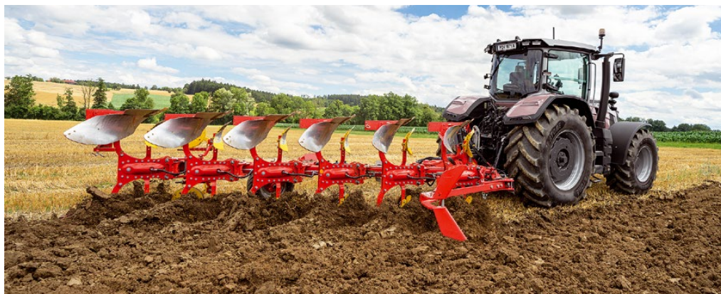
Z orby v brázdě můžete přejít na orbu ON LAND v několika jednoduchých krocích. K tomu slouží přidavné rameno ON LAND pro posouvání rámu směrem ven. Pluh lze proto agregovat i s traktory do větší šířky 3 m.
