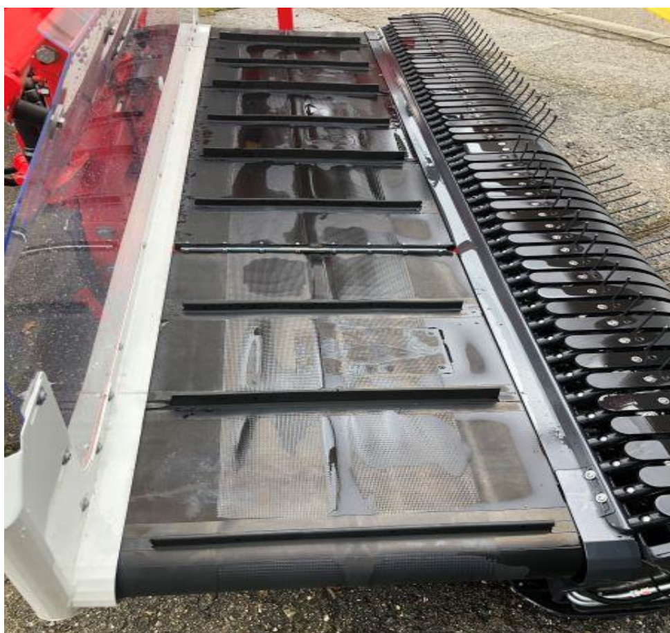
Shazovací pás s možností volby shazování vpravo nebo vlevo. 620 mm široký pás, nastavitelné napnutí pásu bez nutnosti použití nářadí, dělený pás, rychlá demontáž a montáž pásu, vnitřní vodicí drážky, vulkanizované kolíky.
