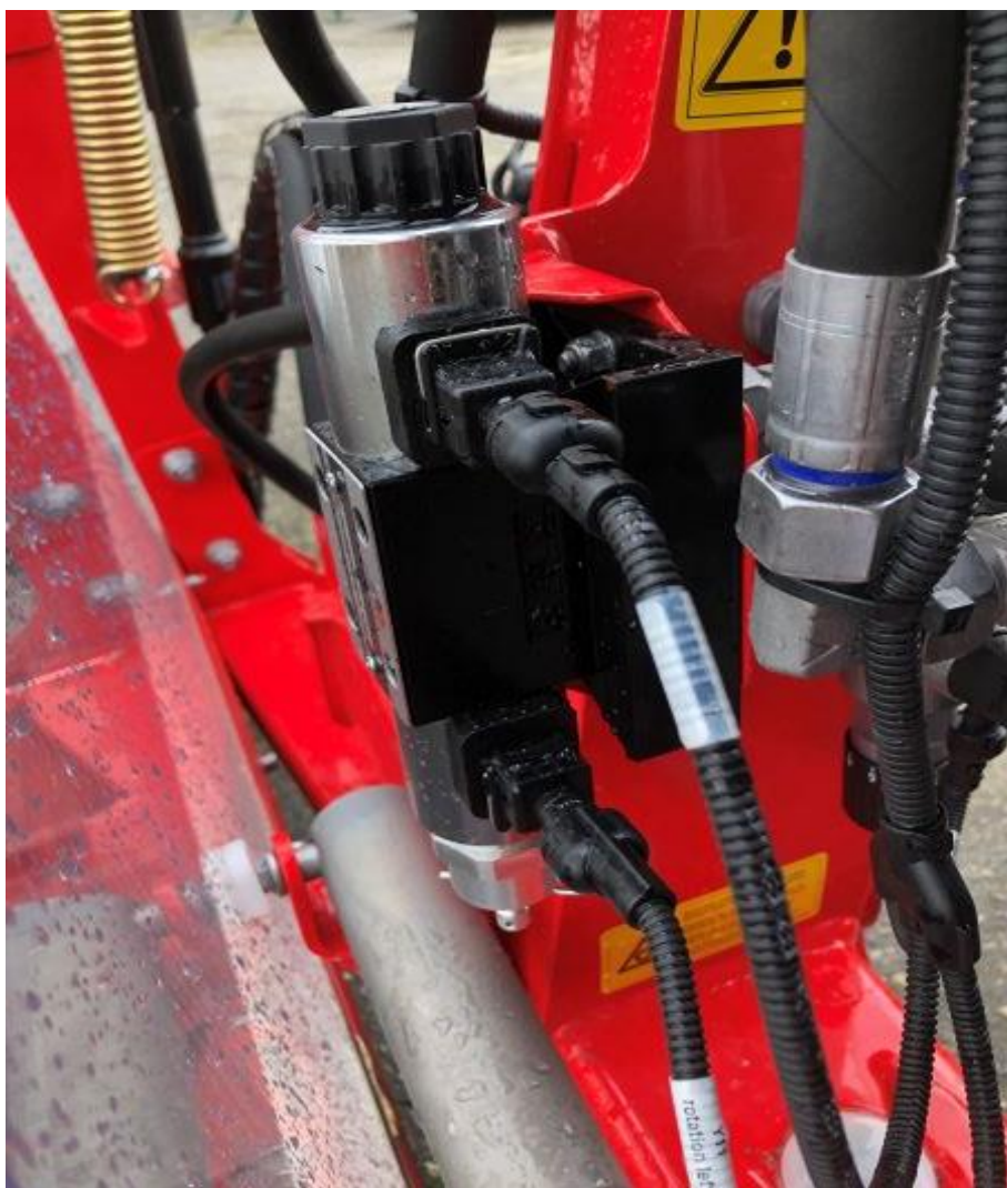
Ventil na změnu směru otáčení shazovacího pásu.
