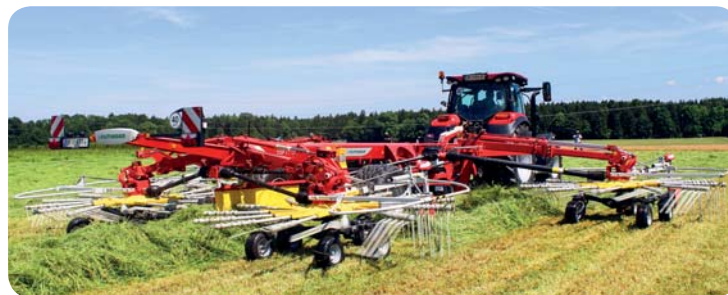
Pracovní záběr lze u nového shrnovače TOP VT 12540 C podle potřeby nastavovat plynule hydraulicky z kabiny traktoru. Díky tomu je možné plynule formovat řádky píce i v klínech pozemků a lehce se vyhýbat překážkám
