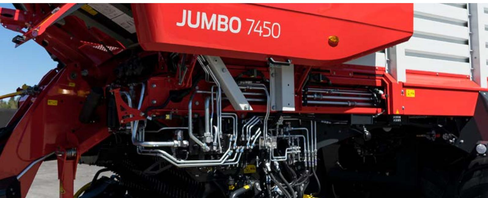
Rozdělení okruhů hydrauliky a elektřiny usnadňuje mj. údržbu a čištění samosběracího vozu. Přehledné uspořádání vedení usnadňuje hledání problémů a zkracují se prostoje.
